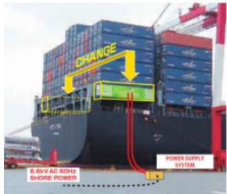
停泊中船舶への陸上電力供給
