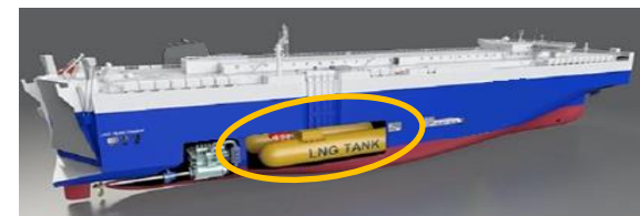
LNG燃料船の燃料タンクのイメージ
