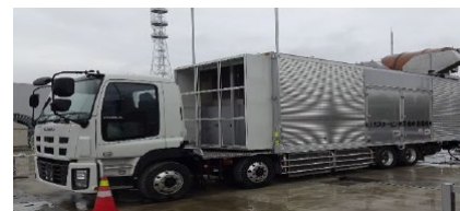
ガスタービン発電機車
