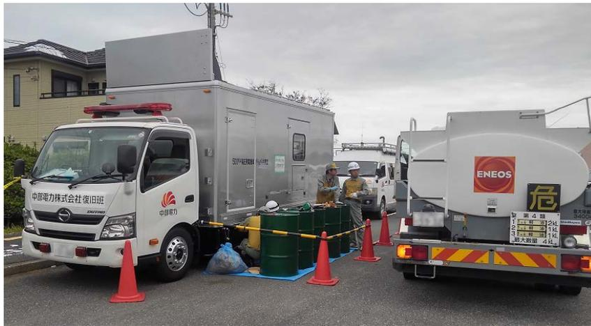
令和元年台風15号対応における電源車への燃料給油
