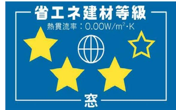
断熱性能を表す熱貫流率を基に、★1～4にて等級を示している。
