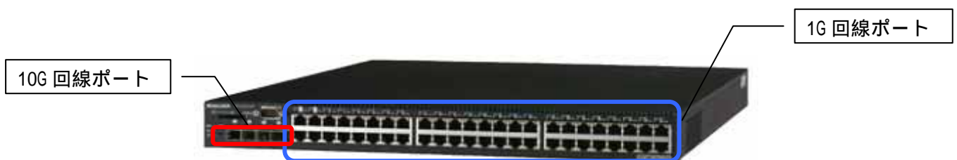
図6 - 3 . L2 スイッチの例 (1G × 48 ポート + 10G × 2)
