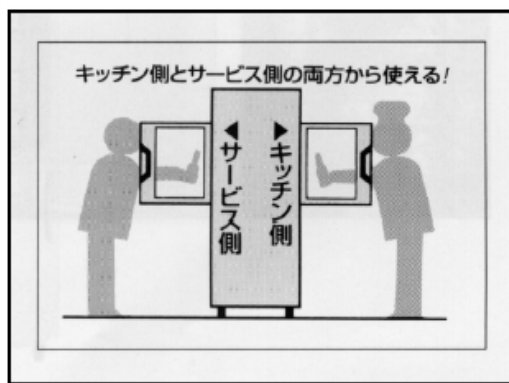
図 d. カートインタイプ (有効内容積の幅 ; 1,000~2,500 L)
