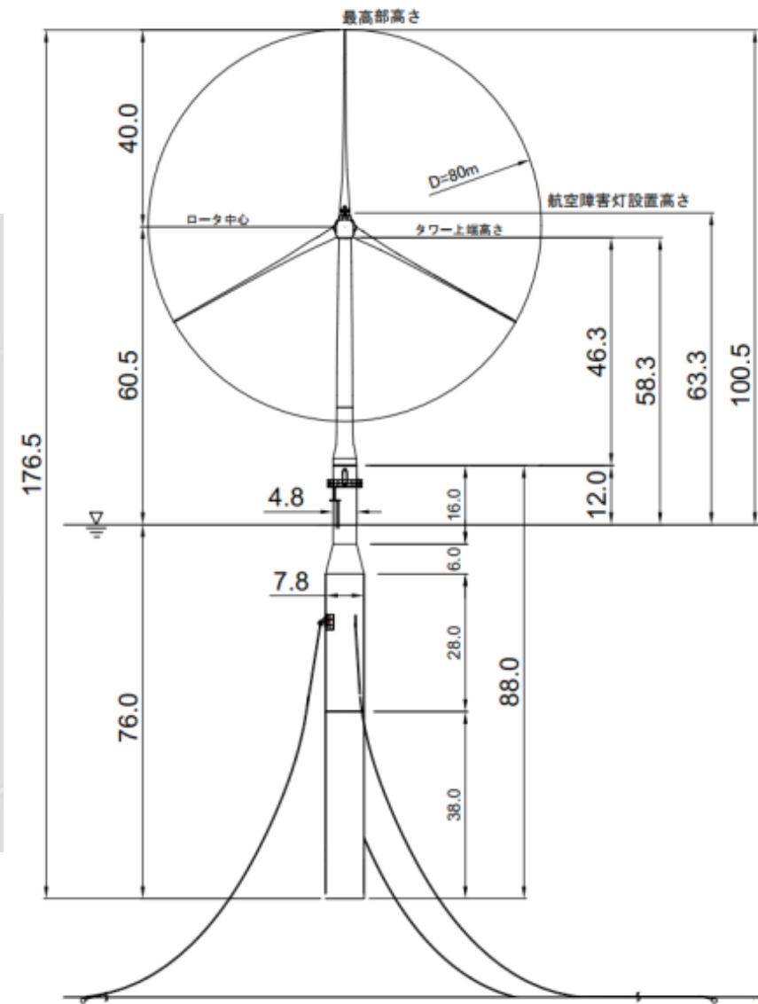
2,100kW風車概要図
