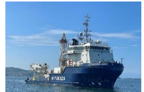
写真1 調査船（コーン貫入試験、PS検層に使用）
