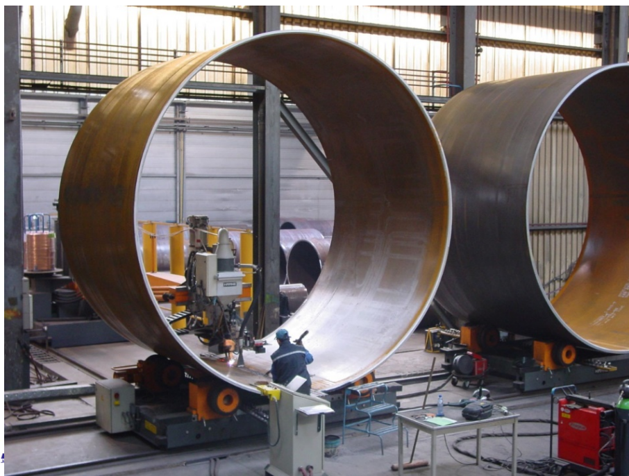
着床式基礎(モパイル)の製造状況(オランダ)
