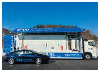
▲移動式水素ステーション
