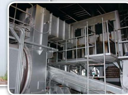
**特長** 鶏糞を800℃以上で燃焼することにより、ダイオキシンの心配がなく排気ガスが無臭です。燃料投入が定量機より行われること、また燃料室が回転し自力攪拌することにより24時間連続運転可能です。
