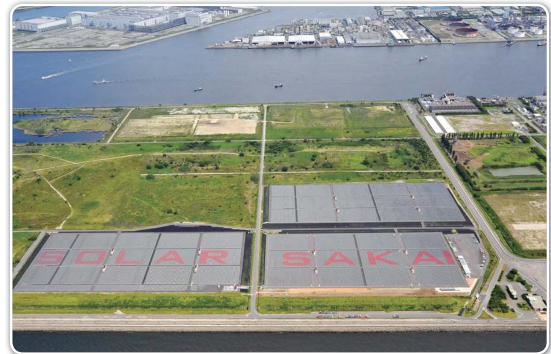
**特長** 出力変動する太陽光発電などの再生可能エネルギーが大量に電力系統に導入された場合の供給信頼度を維持するため、堺太陽光発電所が連系する石津川変電所で蓄電池を用いた電力需給制御システムの試験を開始しています。
