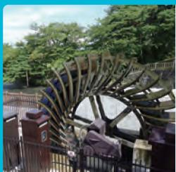
水力発電は河川などの高低差を活用して水を落下させ、その際のエネルギーで水車を回して発電します。
