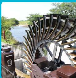
水力発電はダムなどの落差を活用して水を落させ、その際のエネルギーを用いて発電します。現在では農業用水路や小さな河川でも発電できる中小規模のタイプが注目されています。
