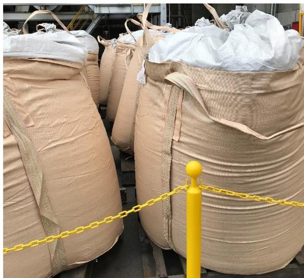
図-1-5-2.区画され、封をした状態で保管されている燃焼灰
