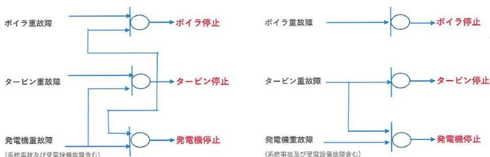
図-3-3-1.ユニット保護インターロックの概念図
