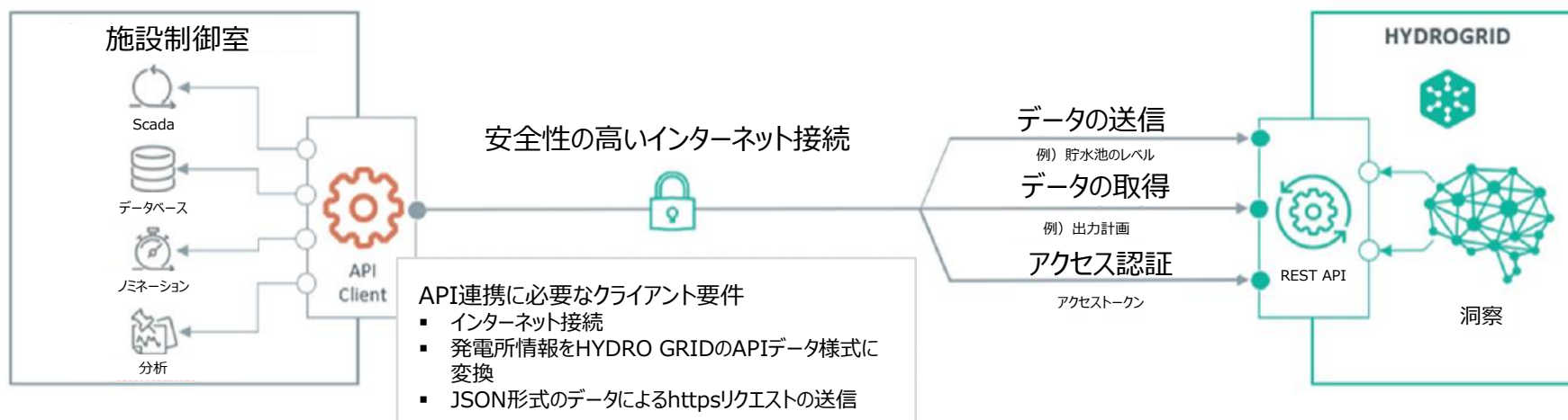
水力発電所の監視制御システムKraft ScadaとHYDROGRID Insight間のデータ連携
