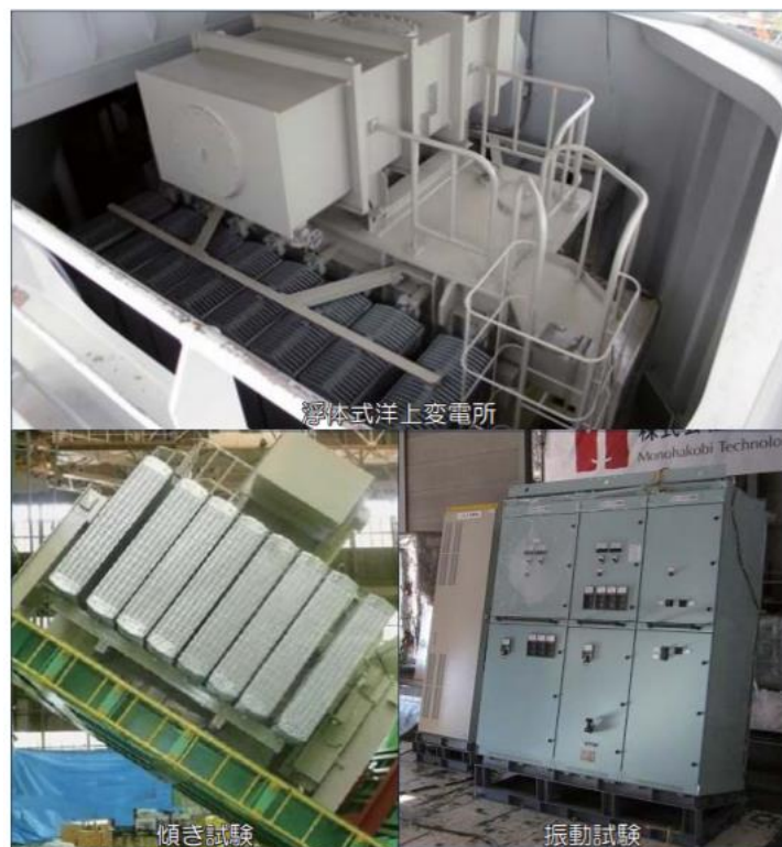
浮体式洋上変電所の性能試験
