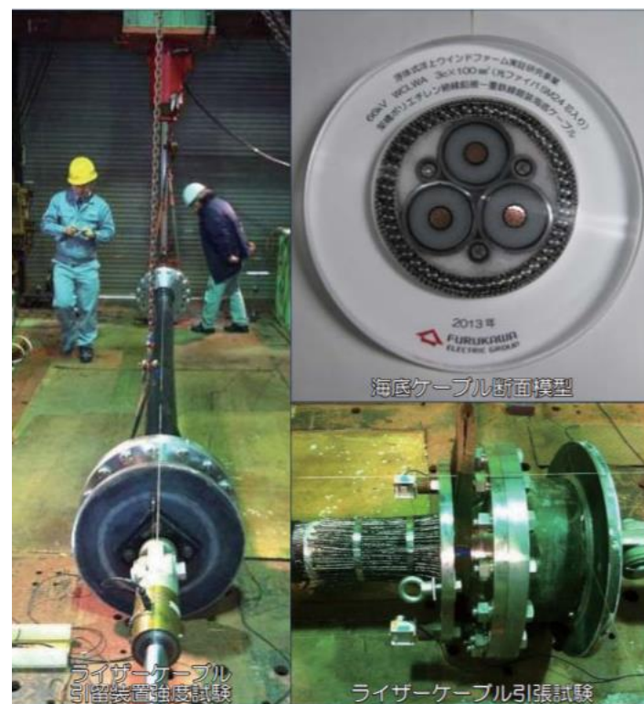
大容量ライザーケーブルの性能試験
