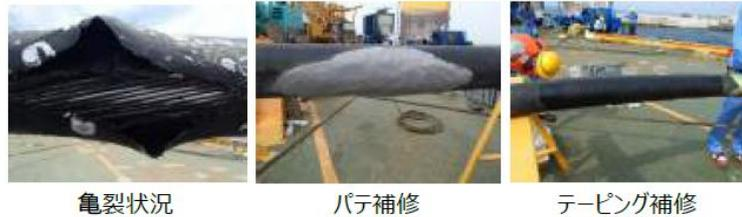
図6 7MW 浮体のライザーケーブルの補修の様子
