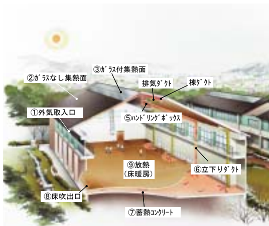
図 2.3.3 空気集熱式太陽熱床暖房システムの例
