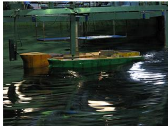
写真 5 採鉱母船とシャトル船との水槽実験
