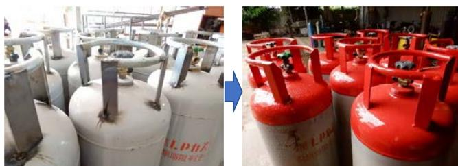
日本製のシリンダーが再利用されているが、溶接の跡がある。
