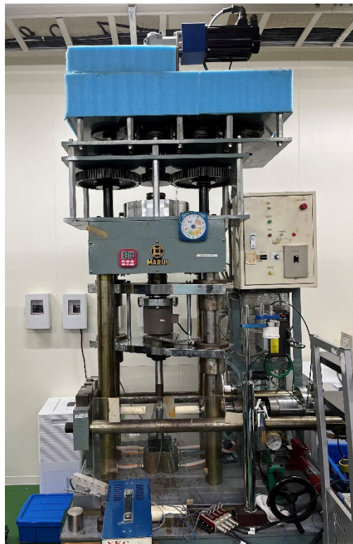
図 12. 二軸圧縮試験機（広島大学）。
