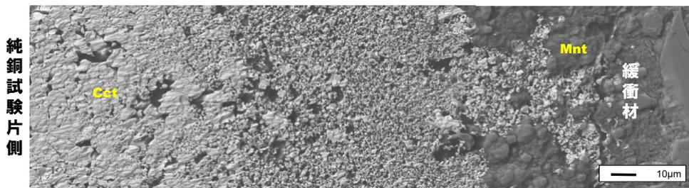
純銅：期間 100 日， $\text{H}_2\text{S}$  ガス濃度 100%，人工海水， $90^\circ\text{C}$
