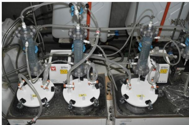
図 2.1-11 U ベンド試験の試験状況
