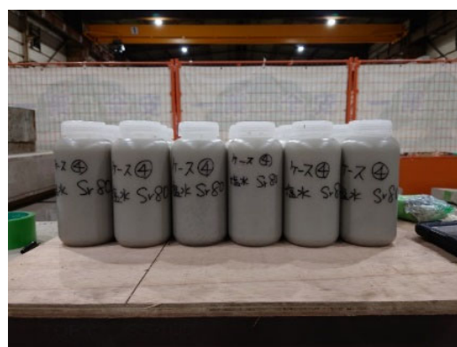
図 2.2-23 塩水 WJ による除去生成物 基本条件時（原環センター・原子力機構，2022）
