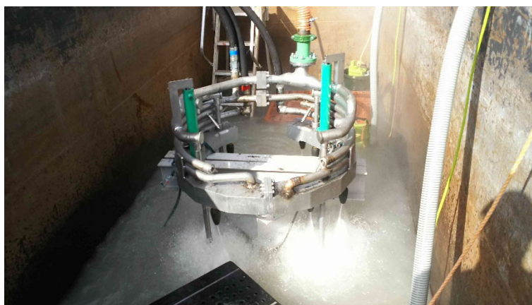
図 2.2-25 噴射試験時のトルネードノズルからの水流の様子
