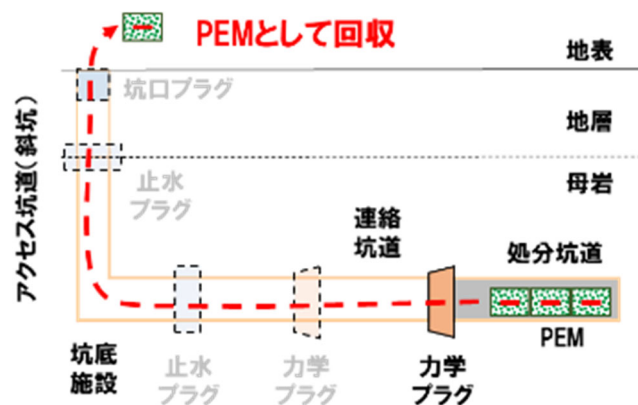
図 2.3-2 処分坑道横置き・PEM 方式（デッドエンド型）における状態 B の模式図
