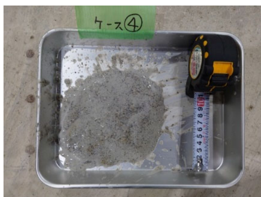
図 2.2-23 塩水 WJ による除去生成物 基本条件時（原環センター・原子力機構，2022）
