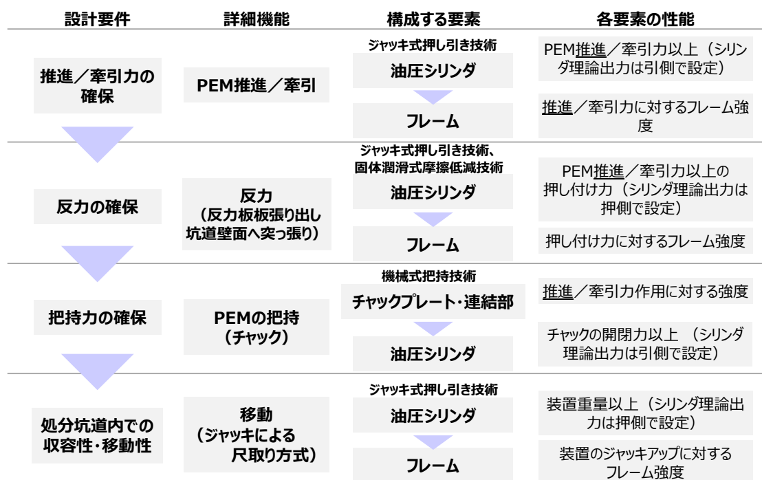
図 3.4-8 定置／回収装置の概念設計の流れ
