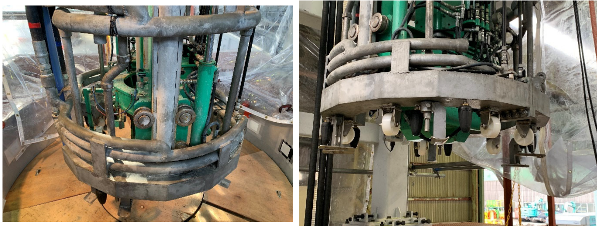
図 2.2-24 WJ 対応の噴射リングの外観
