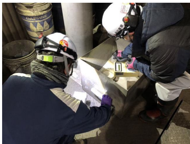
図 5.1.6. 不純物除去剤線量測定・汚染検査
