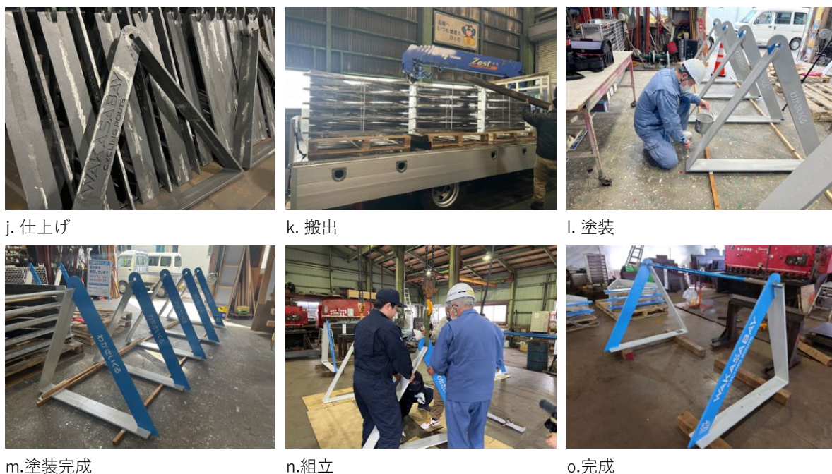
図 2-7 サイクルスタンドの製造工程
