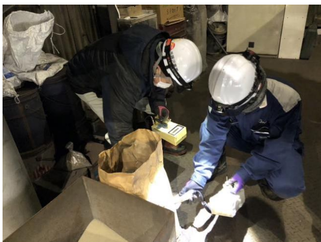
図 5.1.5. 添加物線量測定・汚染検査
