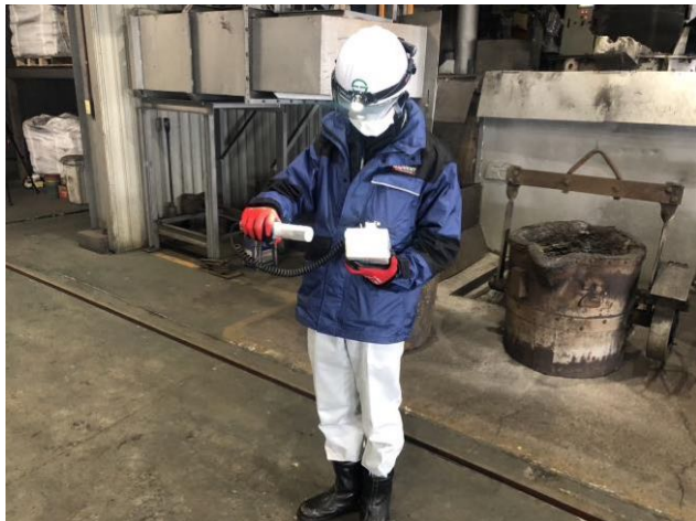
図 5.1.1. 溶融エリア空間線量当量率測定
