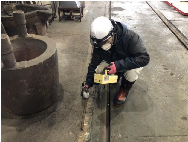
図 5.1.7. 鉄棒汚染検査
