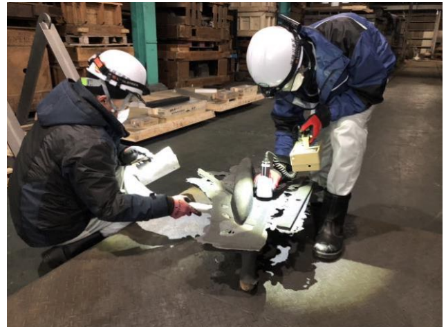
図 5.1.10. 製造物(ボート) 線量測定・汚染検査
