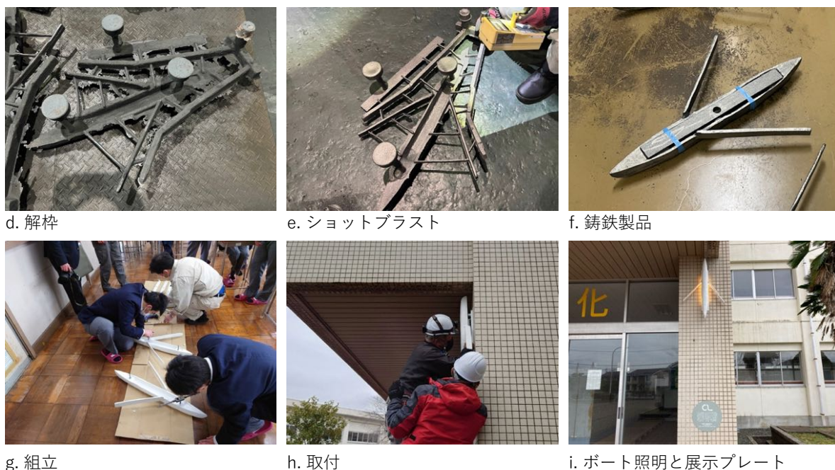
図 2-10 ボート照明の製造・取付工程
