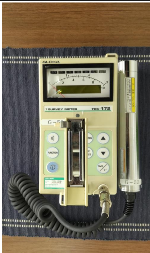
図 2.3.1. シンチレーション式サーベイメータ
