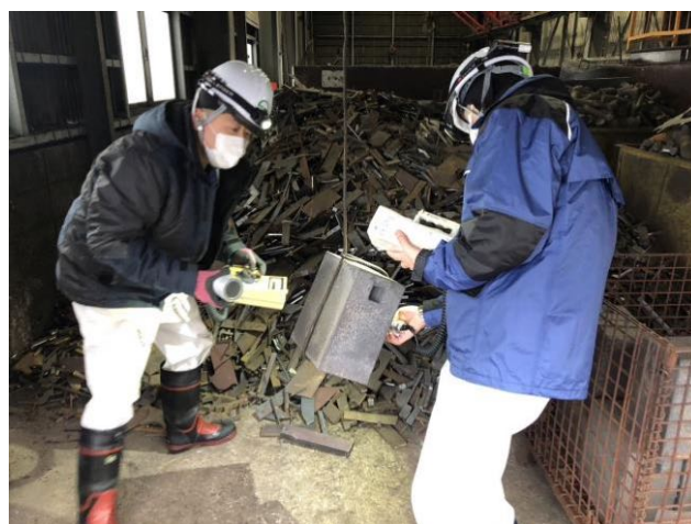
図 5.1.4. インゴット線量測定・汚染検査
