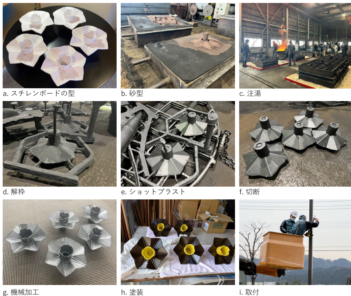
図 2-13 水仙照明の製造・取付工程
