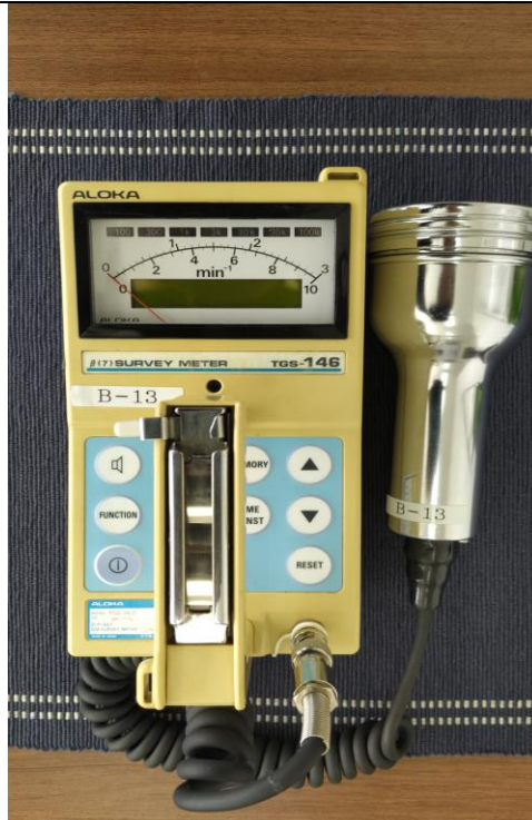
図 2. 3. 2. GM 管式サーベイメータ
