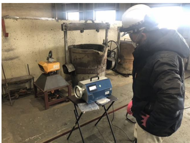
図 5.1.3. 空气中汚染濃度ダスト採取
