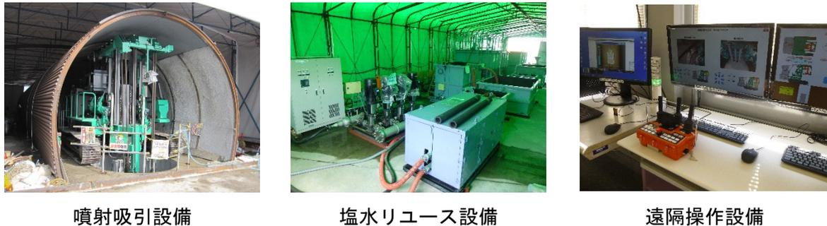
図 3.4-3 緩衝材除去システムを構成する設備
