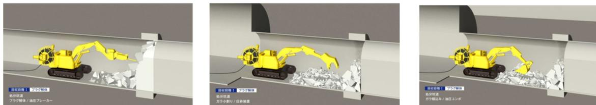
図 3.3-3 バックホウと解体用アタッチメントによる力学プラグの撤去のイメージ (NUMO, 2021)
