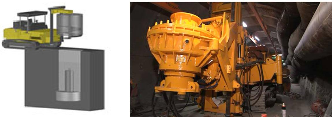
図 3.4-2 ドリリングバケットによる上部埋戻し材の除去のイメージ
