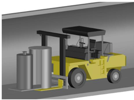
遮蔽コンテナ+搬出装置（遠隔操作）
