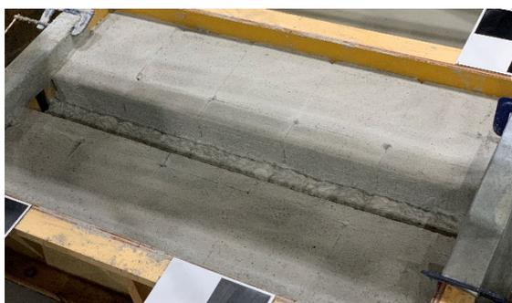
トルネードノズルによる溝状の切削痕の例
