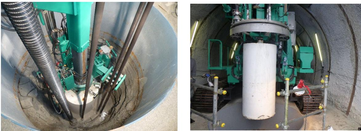
図 3.4-7 転倒防止のオーバーパック把持機構と路盤上への引き上げ
