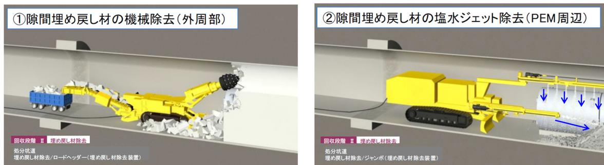
図 3.5-2 PEM 周囲の隙間充填材の除去方法の概念イメージ (NUMO, 2021)
