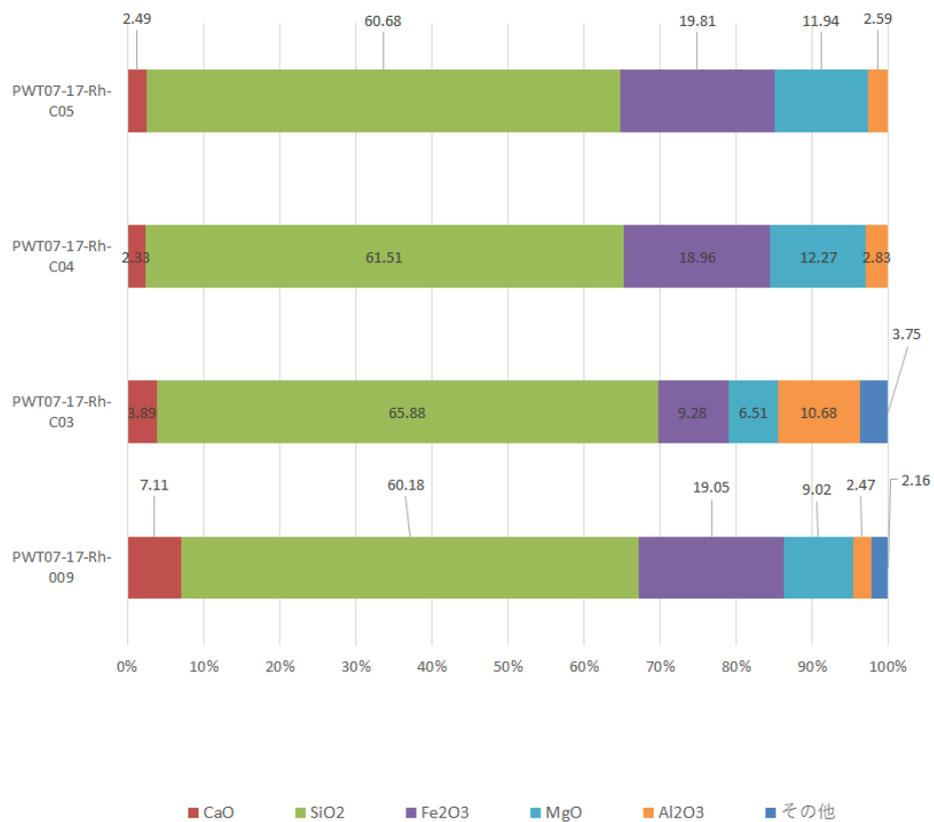
図 4-2 各試料の XRF 分析結果（酸化物表記、CO<sub>2</sub> を含まず）
