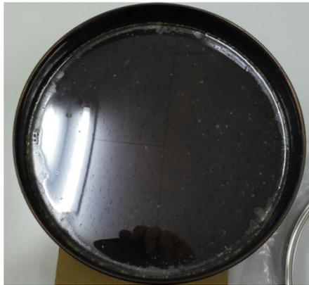
図 3.1-2 モックアップ試験におけるアニーリング後の BPI ガラスの概観
