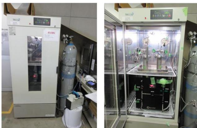
図 2.1-37 試料のガス置換実施状況
