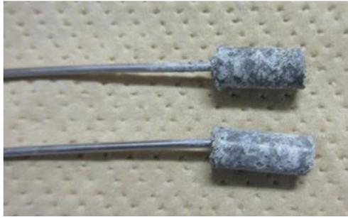
図 2.1-21 試料温度測定用に熱電対を埋め込んだ OPC モルタル試料（φ6.5mm×13mm）
