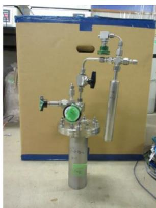
図 2.1-38 ステンレス製圧力容器及びガス取り出しタンク
