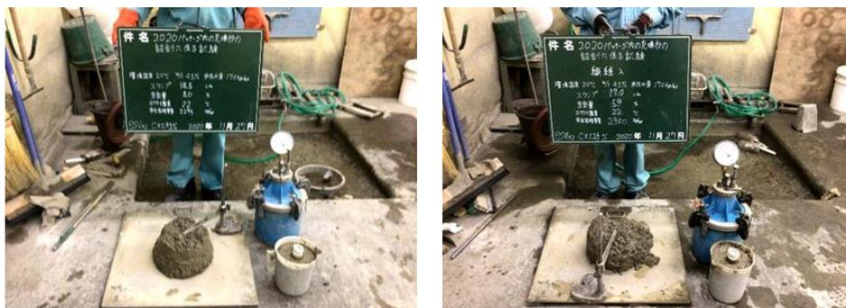
図 2.1-50 スランプ及び空気量の測定状況（モックアップ製作時）
