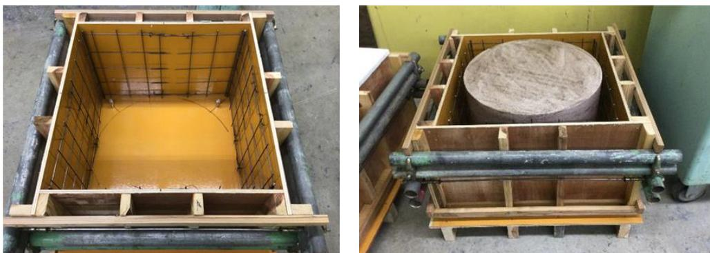
図 2.1-49 型枠の外観
