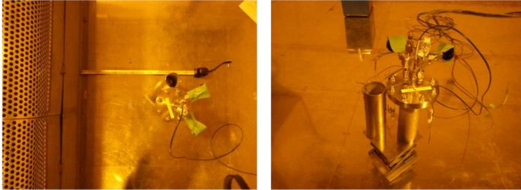
図 2.1-17 国立研究開発法人量子科学技術研究開発機構（QST）高崎量子応用研究所でのコンクリートの照射試験状況
