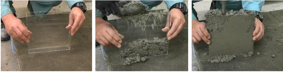
図 2.1-46 アクリル製型枠への充填性作業状況
