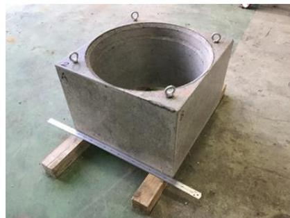
図 2.1-52 脱枠後のモックアップの外観
