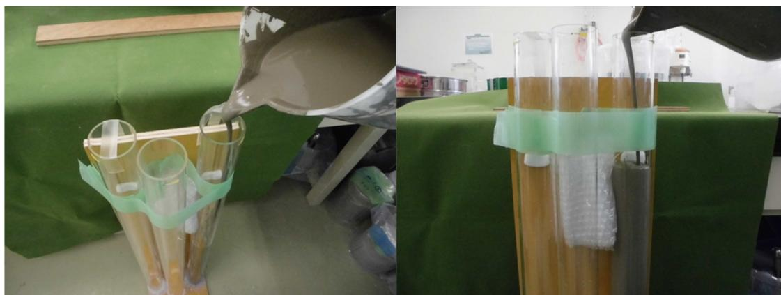
図 2.2-82 流し込み充填作業(5cmφ×89cmH)の状況
