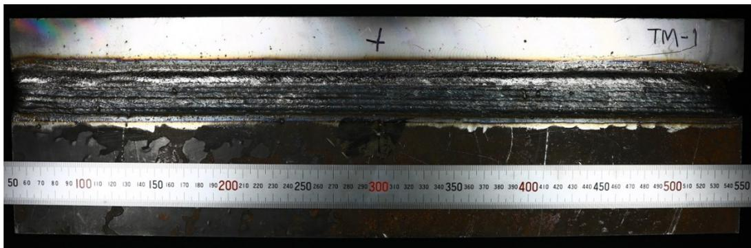
図 2.1-44 伝熱試験体外観(TM-1) (平蓋構造)
