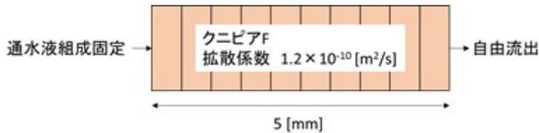
図 2-63 解析モデルの概要
