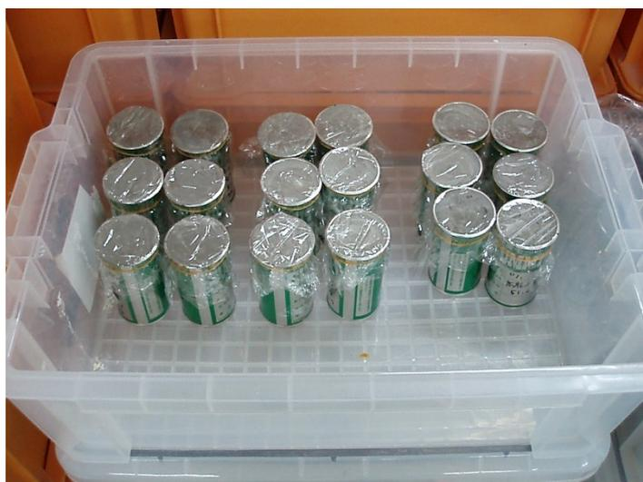
図 2.2-77 圧縮強度用試験体の養生状況
