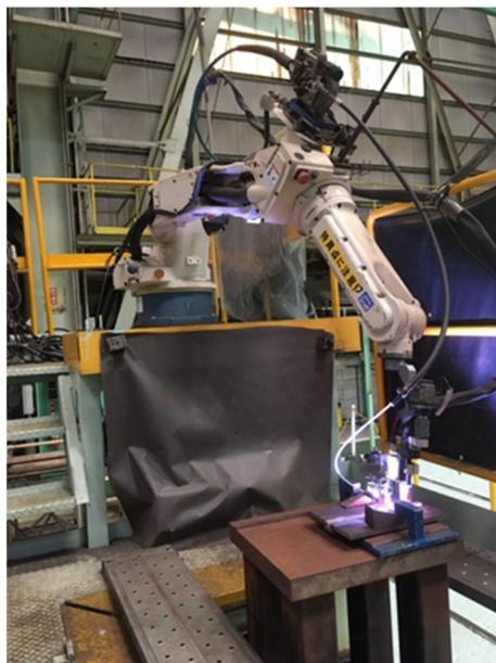
図 2.1-55 試験体溶接状況（2重蓋構造）
