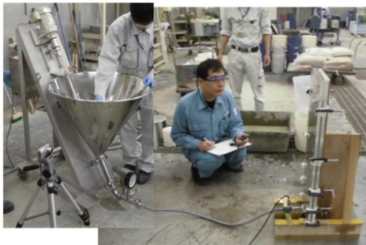
図 2.2-86 充填状況の確認試験装置の概要図
