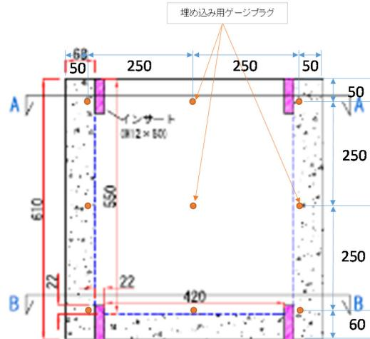
図 2.2-47 ゲージプラグ設置位置 (図中の単位は mm)
