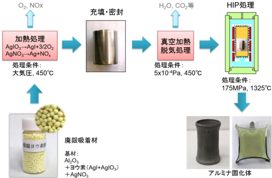
図 2.1-1 アルミナ HIP 固化体の製造フロー
