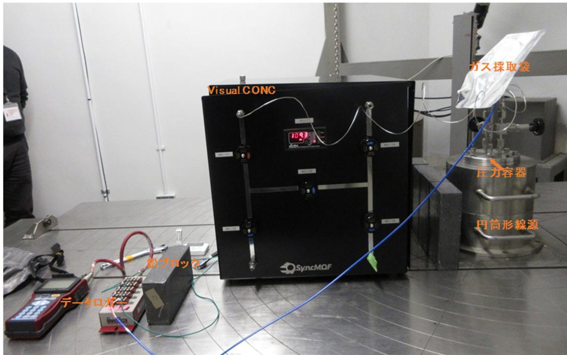
図 2.2-28 内圧測定試験状況（測定開始前）
