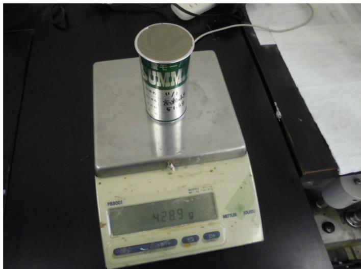
図 2.2-76 単位容積質量(生比重)測定
