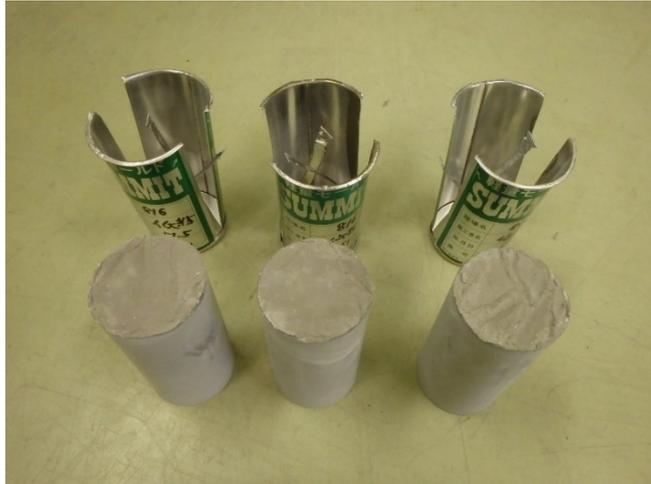
図 2.2-78 圧縮強度用試験体の状況（脱型後）
