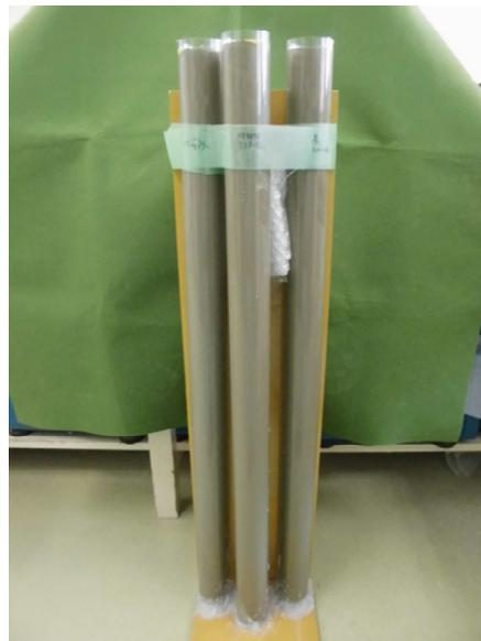
図 2.2-84 鉛直管試験装置（すき間充填材の充填直後）
