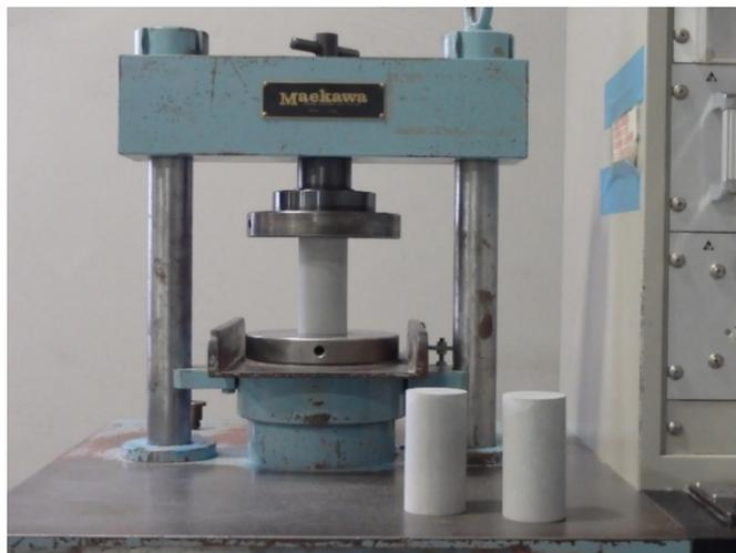
図 2.2-80 圧縮強度試験の状況
