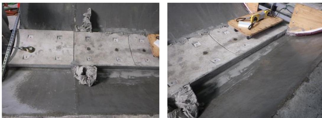
図 3.4.5-1 排土板による残留物の押し退け状態 (要素試験 2)
