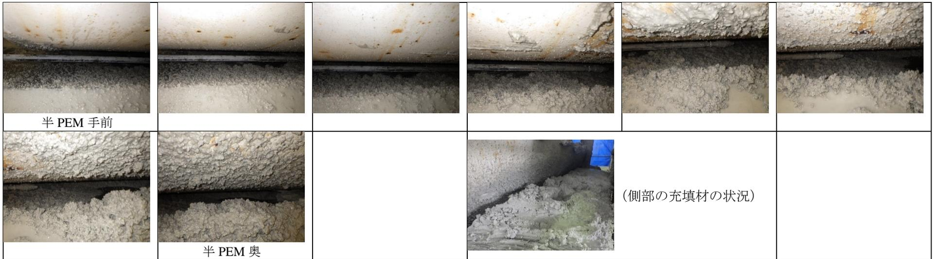
図 5.5.2-28 試験ケース 3-2 トルネードによる前進除去後 (メジャーなし：側部への充填材多く設置できず)
