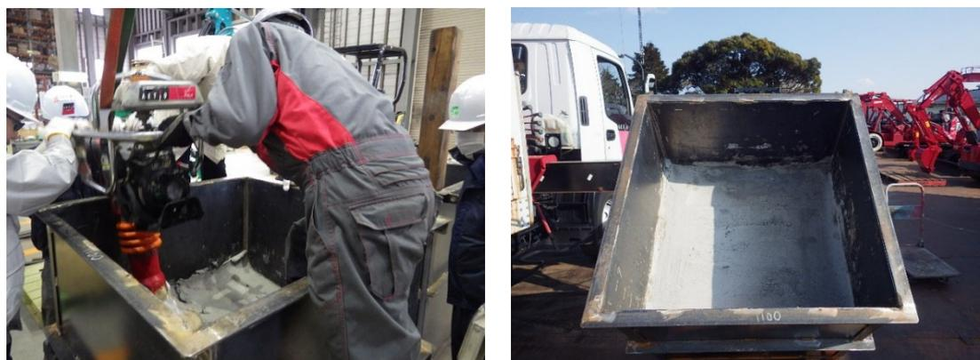
図 2.2.3-22 上部開放部の充填材除去技術の検討における試験土槽
