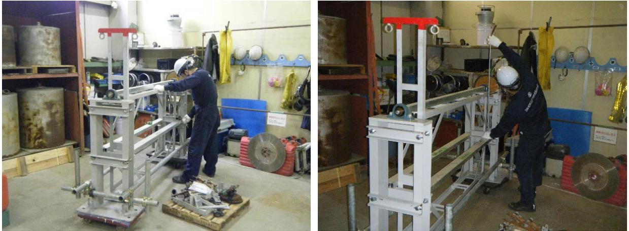
図 5.5.2-47 改良後の流体的除去装置（振り子式）
