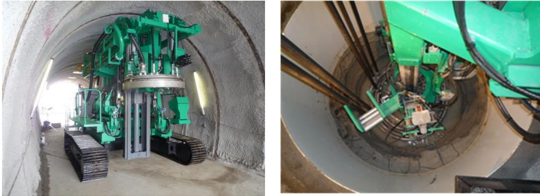
図 2.2.1-2 処分孔縦置き定置方式を対象とした緩衝材除去試験の様子 [1]
