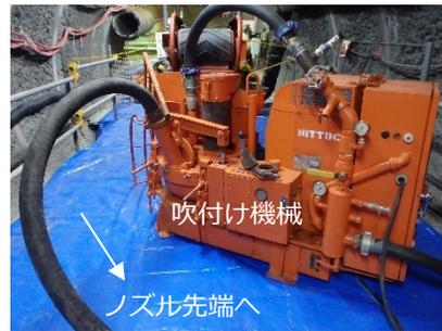
吹付け機械からノズル先端への材料圧送
