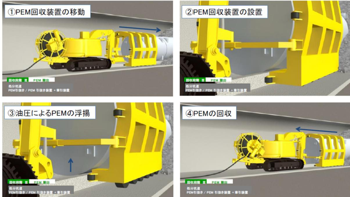
図 2.3.1-4 埋戻し材除去後の PEM の回収方法のイメージ[15]
