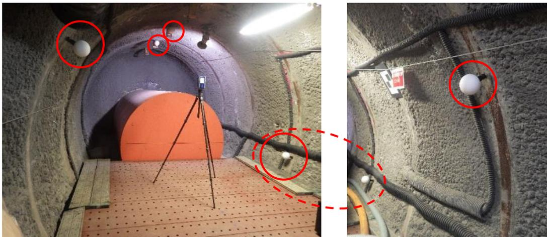
図 4.3.3-37 3D スキャナによる計測 球形ターゲット設置位置 (計 5 点)
