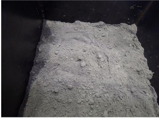
(a) 型枠内への材料の撒きだし
