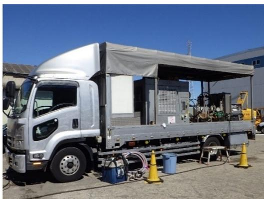
(a) 高圧水発生装置+車両
