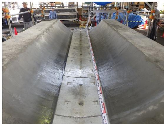
図 5.5.2-38 モルタル区画 2 の試験前 (左側狭隘部にて試験実施)
