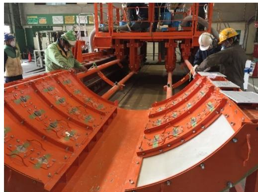
図 1.3.2-2 狭隙部充填装置外観
