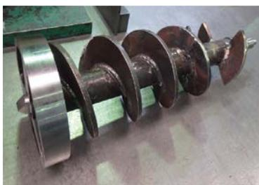
図 5.4.2-2 オーガアタッチメント説明図、オーガスクリュー写真
