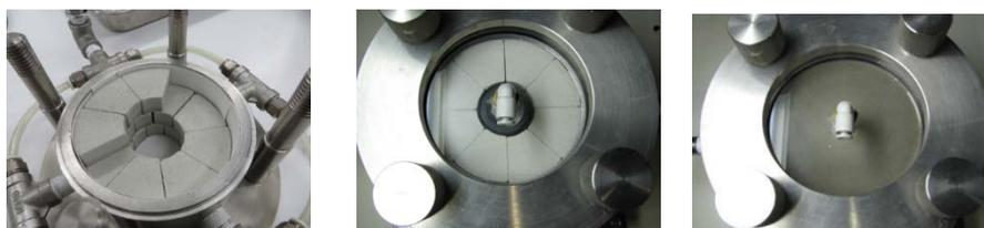
図 1.3.4-1 緩衝材可視化試験（ブロック定置方式の模擬）
