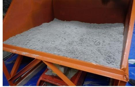
充填材の材料ホッパーへの供給
