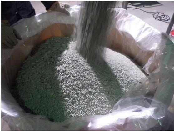
混合後の隙間充填材
