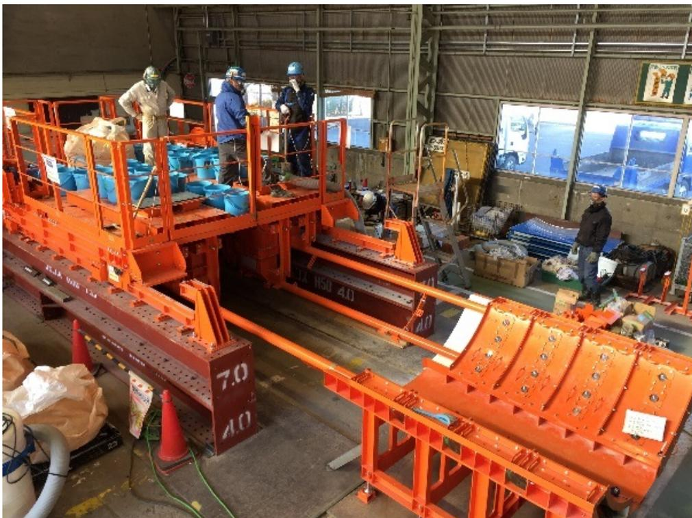
図 4.2.3-14 下部狭隘部隙間充填装置全景（平成 29 年度地上予備試験実施状況）
