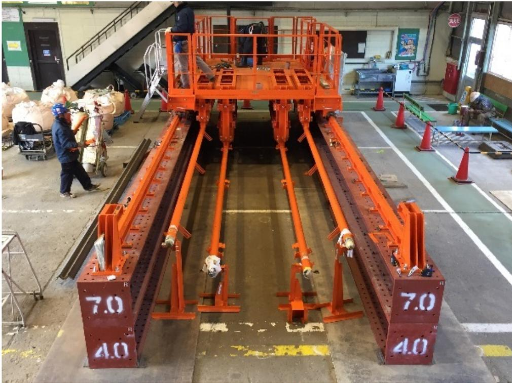
図 4.2.3-13 下部狭隘部隙間充填装置全景
