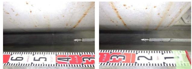
図 5.5.2-19 直射ノズル 20MPa 噴射後
