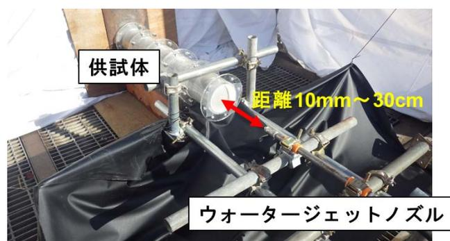
図 1.3.3-4 奥行き方向の切削試験状況
