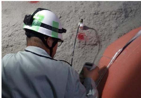
図 4.3.3-34 誘電率計測状況
