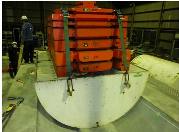
図 2.2.3-15 横倒し組み半割れ構造 PEM 容器の活用[12]
