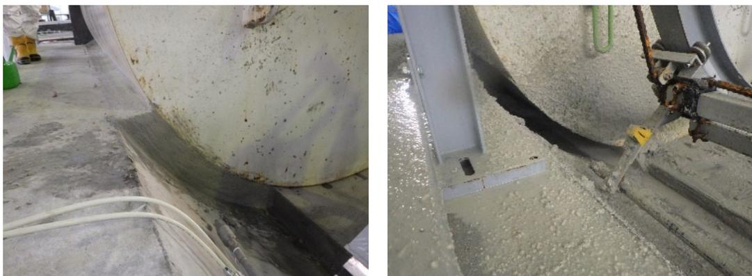
図 2.2.3-20 下部狭隘部の充填材除去技術の検討における試験土槽
