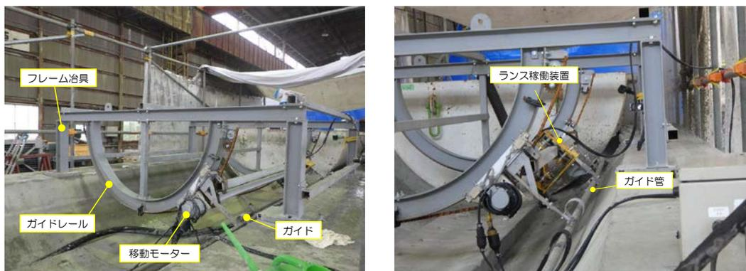
図 5.5.2-7 除去装置 2 (ガイドレール式) 写真
