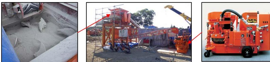
図 1.3.2-5 吹付け用充填材材料の製造プラント
