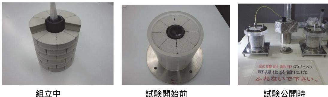
図 2.5.3-1 緩衝材ブロックの一体化挙動の可視化試験の様子
