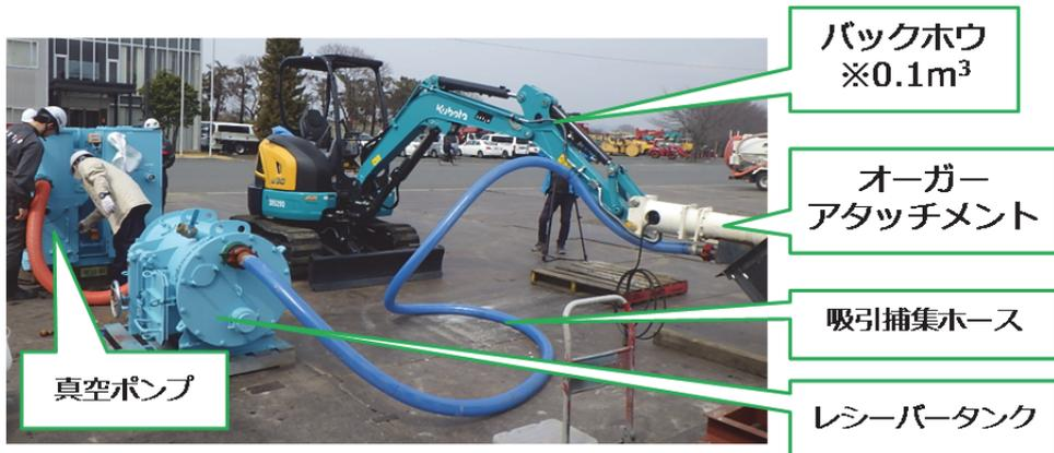
図 2.4.4-2 機械的除去装置 全景
