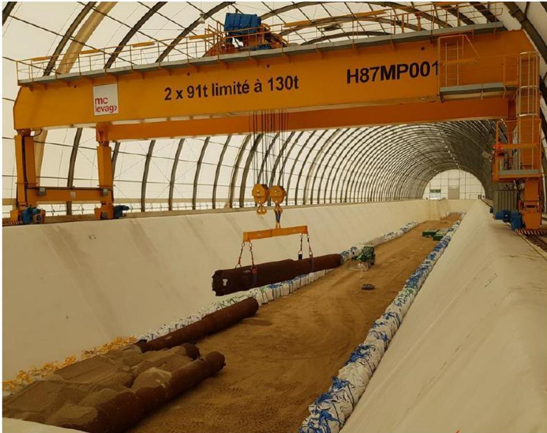
図 3.3-4 特化処分セル内の熱交換器シリンダー
