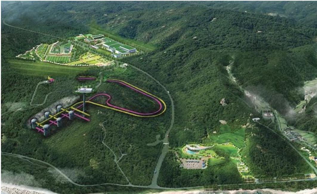
図 1.3-2 月城低中レベル放射性廃棄物処分センター 第1段階 地下空洞処分施設(概念図)
