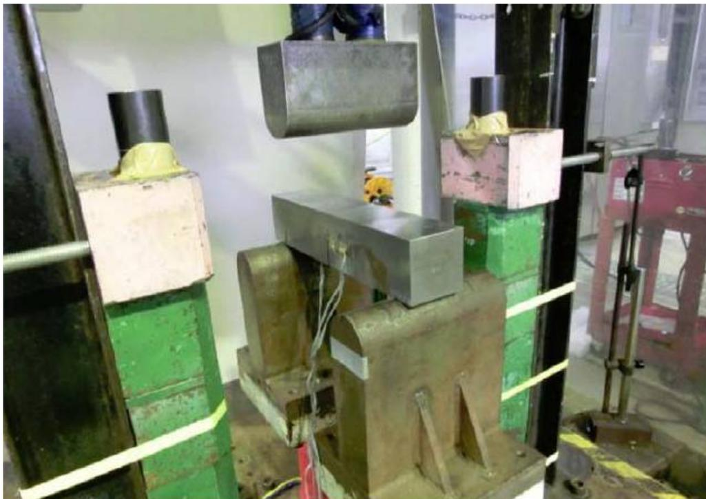
図 3.2.1-16 動的破壊靱性試験の試験要領（恒温槽で冷却後取り出して速やかに試験）
