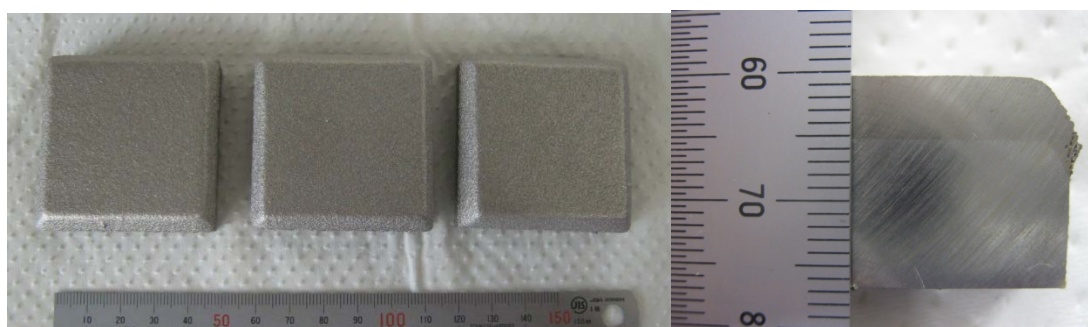
図 2.1.2-6 厚さ 5 mm の溶射膜の外観および断面の状況
