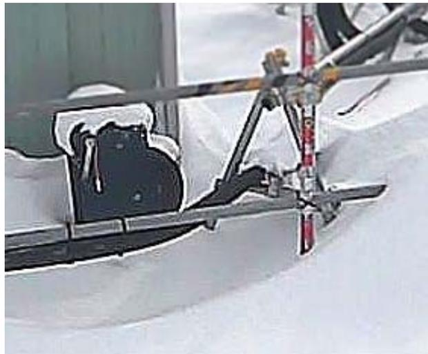
図 4.8-11 ウェブカメラによる積雪量測定
