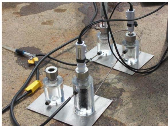
図 4.7-14 フローセルによる物理パラメーター測定
