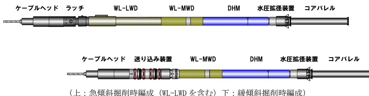
図 4.2-2 掘削用ダウンホールツールス
