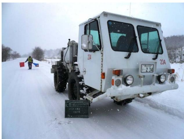
図 4.6-1 中型バイブレータ震源
