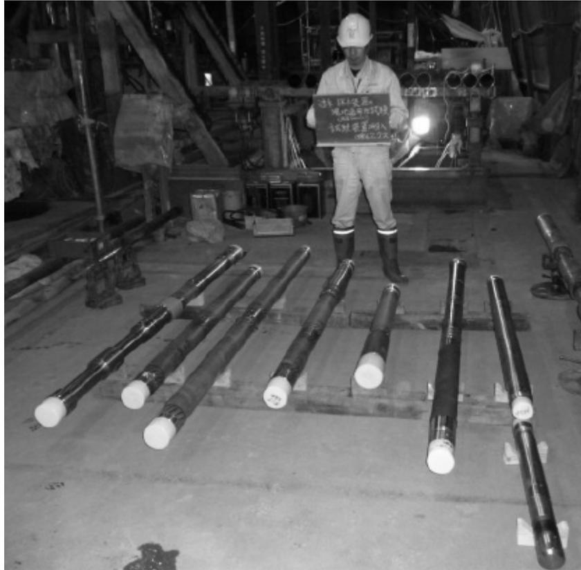
図 4.4-2 透水試験・採水・イメージング装置の全体写真
