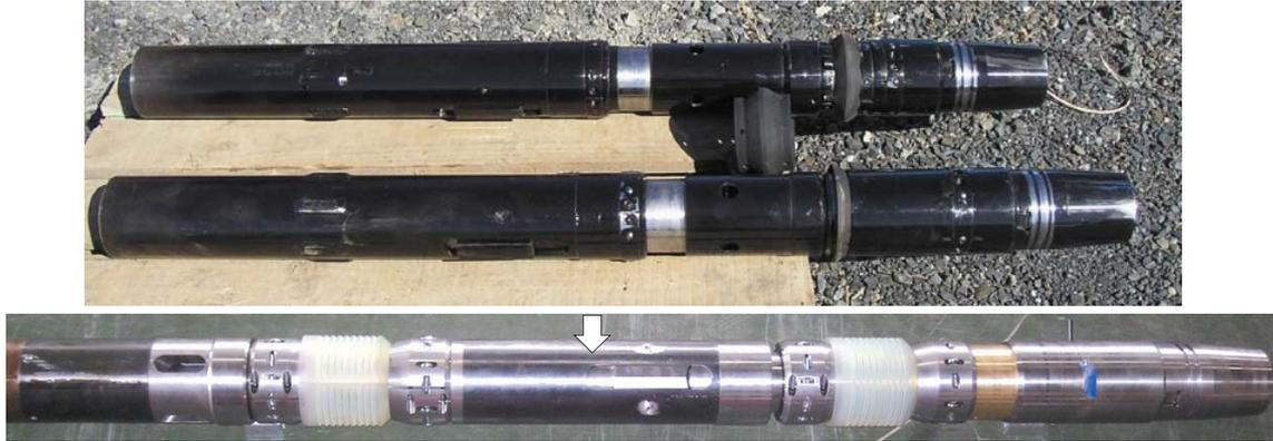
図 4.2-10 押し込み補助装置
