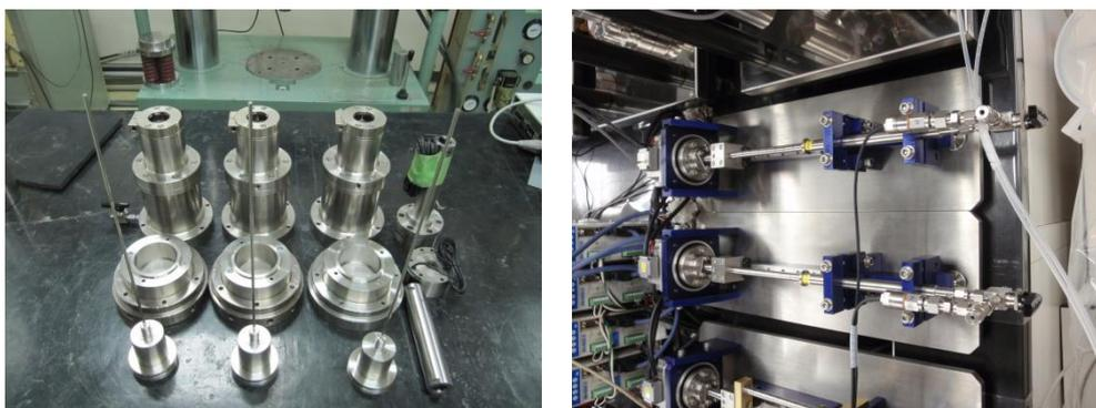
図 3.2.1-4 化学・力学連成モデル試験用セルとフローポンプ透水試験機
