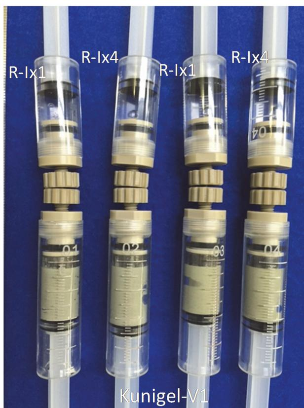
図 2.1.3-2 シリンジ反応容器（反応前）
