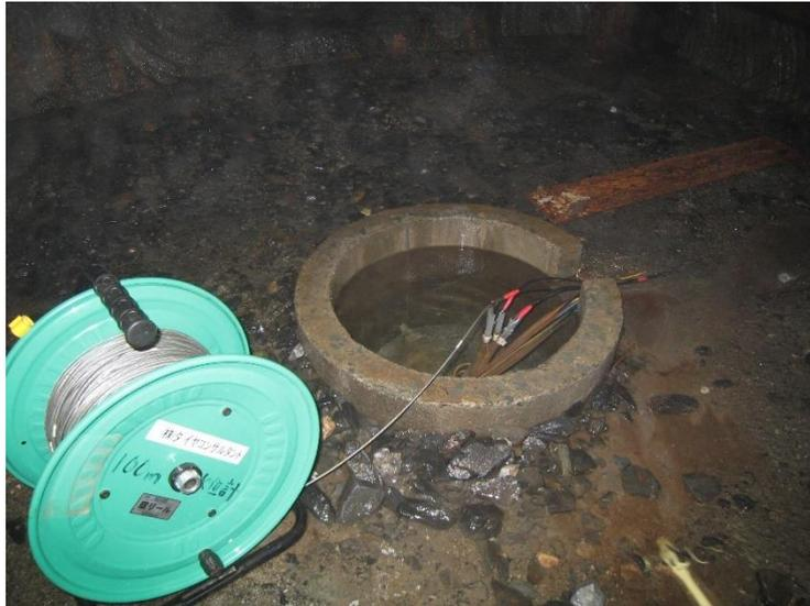
図 4.6-54 手ばかり水位計による水位測定状況
