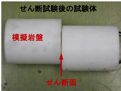
図4.3.3-9 せん断後の試験体の状況
