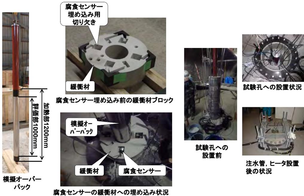
a. 緩衝材中への腐食センサー設置状況と試験孔への試験体の設置状況
