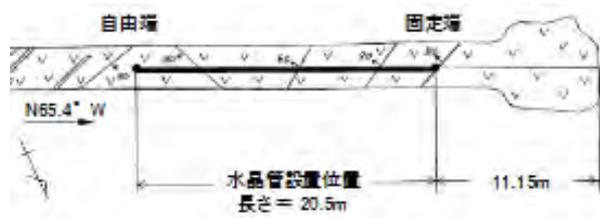
図4.3.2-2 釜石鉱山・岩盤ひずみ計の配置図
