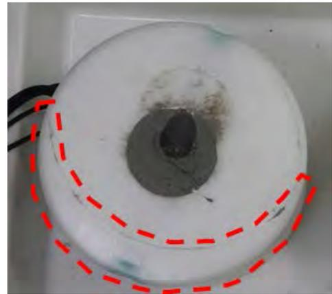
模擬岩盤とせん断容器の干渉により生じた擦過面（破線部分）
