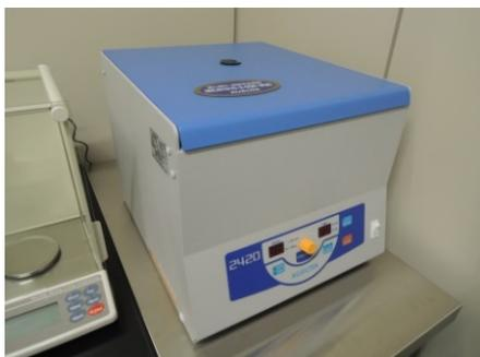
図 3.1-26 重液分離で用いる遠心分離器
