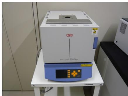
図 3.1-27 加熱処理用マッフル炉
