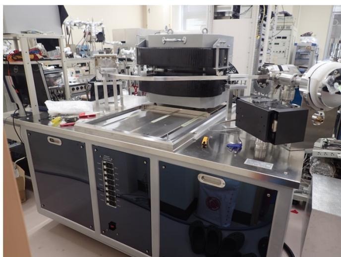
図 3.3-32 土岐地球年代学研究所に導入した希ガス質量分析計の写真
