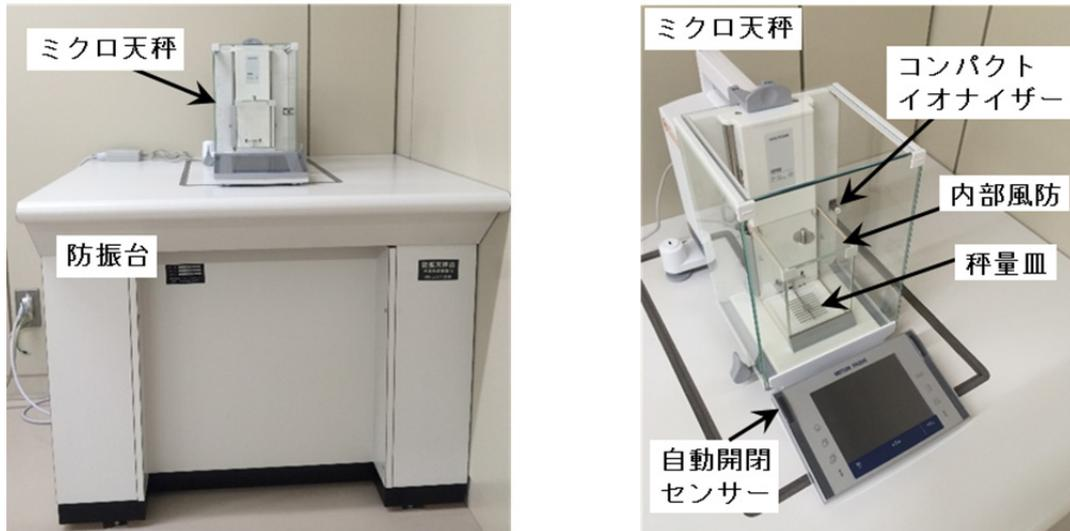
図 3.3-17 土岐地球年代学研究所に導入したマイクロ天秤の写真
