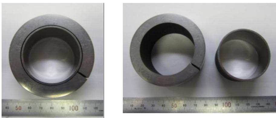
図 2.2.3-6 被覆管より採取したジルコニウム試料
