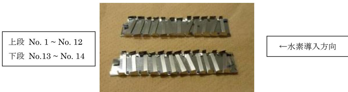
図 2.2.4-4 水素化時の試料配置
