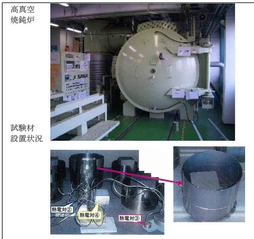
図 2.2.1-3 高真空焼鈍処理状況
