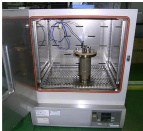
図 2.2.1-9 中温（160℃）における浸漬試験状況
