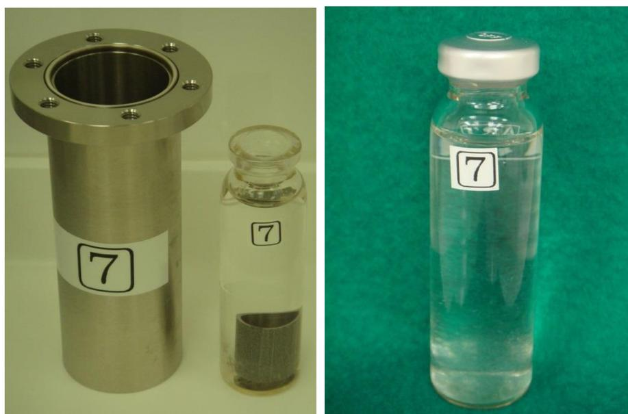
図2.5.2-2 照射済み燃料被覆管の浸漬試料(左)および液相試料(右)の外観写真
