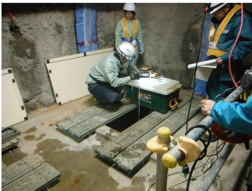
図 10.7.1-4 湧水量測定状況
