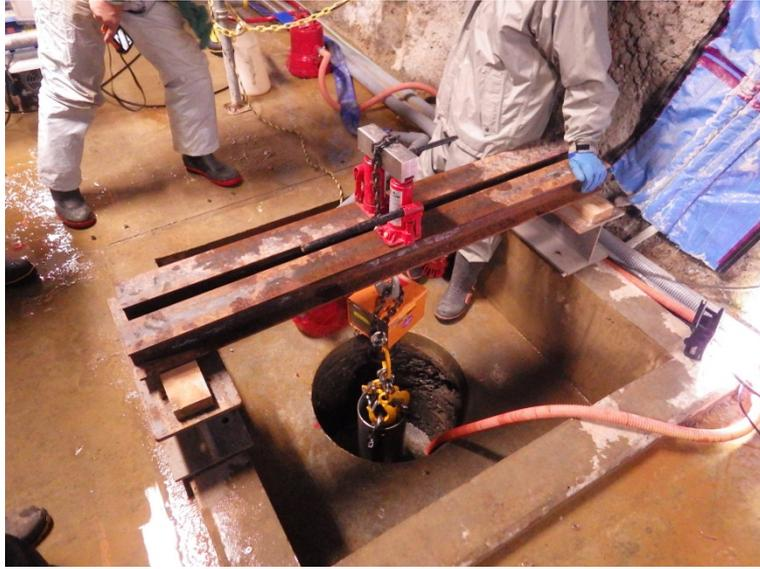
図 10.11.4-1 ジャッキアップによる試験体引上げ状況
