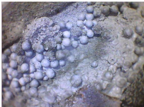
図 10.12.5-2 同位置でのベントナイトペレットの膨潤状況（再冠水開始 10 分後）
