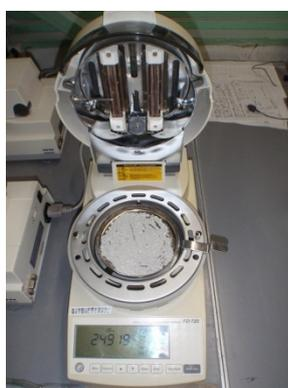
図 9.4.3-5 赤外線水分計への試料投入
