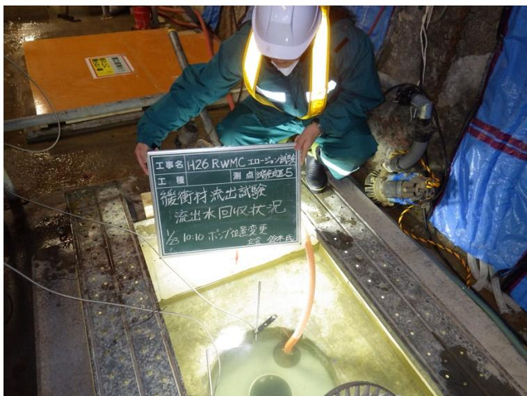
図 10.12.3-1 ポンプ吸水位置変更（1回目；試験体上）
