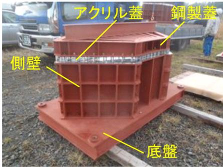
図 9.4.3-8 実規模 1/4 リングモールド外観
