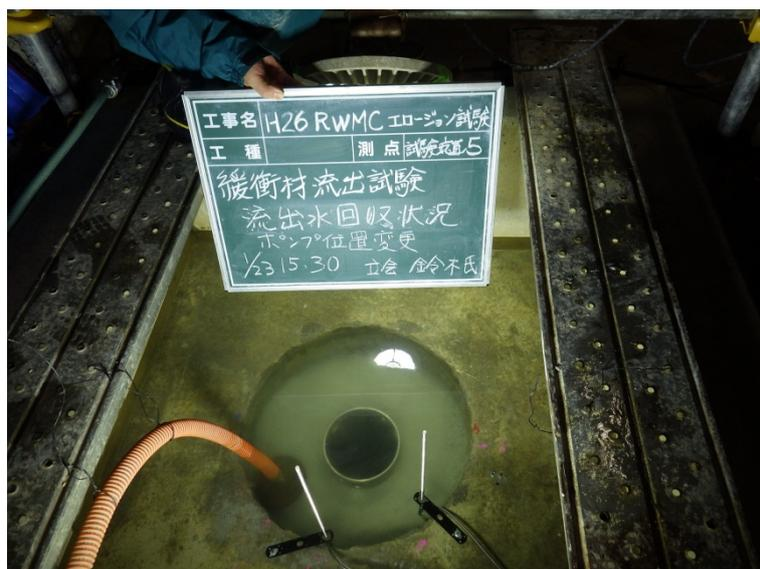
図 10.12.3-2 ポンプ吸水位置変更 (2 回目 ; 試験体上面+2cm)
