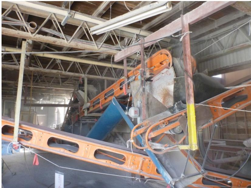
図 10.5.1-9 混合材料のベルトコンベアー輸送
