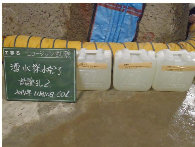
図 10.8.1-2 採水した試験孔 2 の湧水 (60L)
