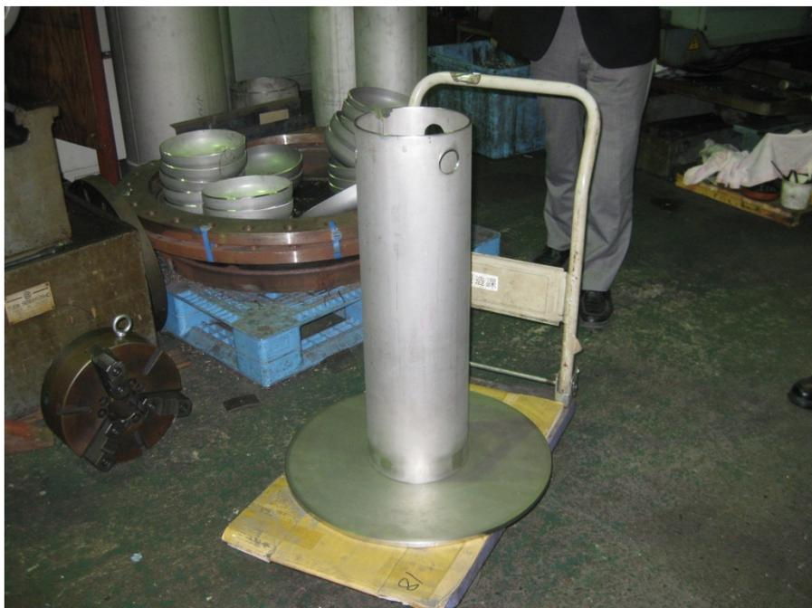
図 10.6.3-1 エロージョン試験用定置治具
