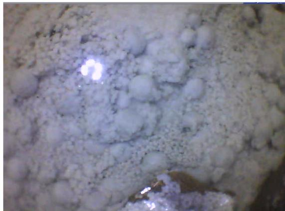
図 10.12.5-5 同位置でのベントナイトペレットの膨潤状況（再冠水開始 25 分後）
