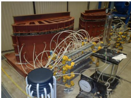
図 9.4.3-25 緩衝材への給水状況
