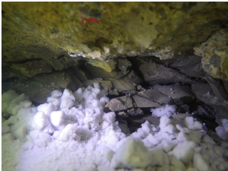
図 10.12.5-8 ベントナイトペレットの水中での膨潤状況（再冠水開始 24 時間後）
