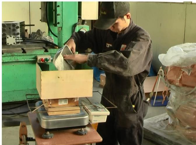
図 10.5.2-2 材料計量の様子
