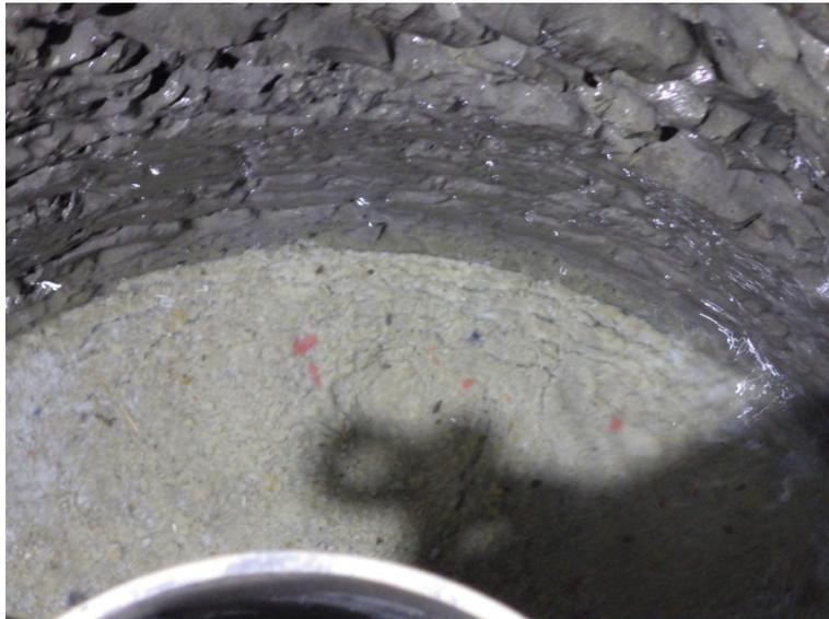
図 10.11.5-5 岩盤と緩衝材の隙間の閉塞状況（1 か月後）
