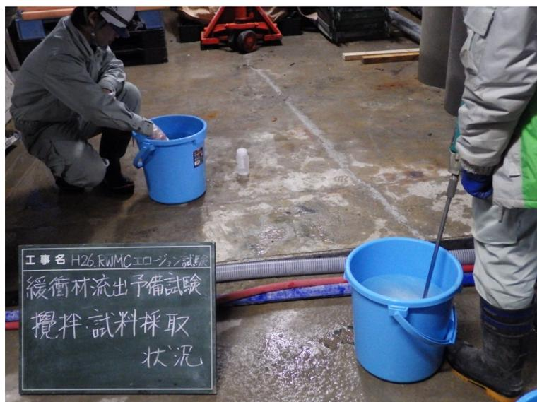
図 10.11.3-3 採水後の攪拌・試料採取状況
