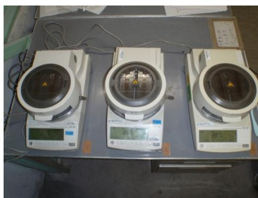
図 9.4.3-6 含水比計測 (3 点/バッチ)
