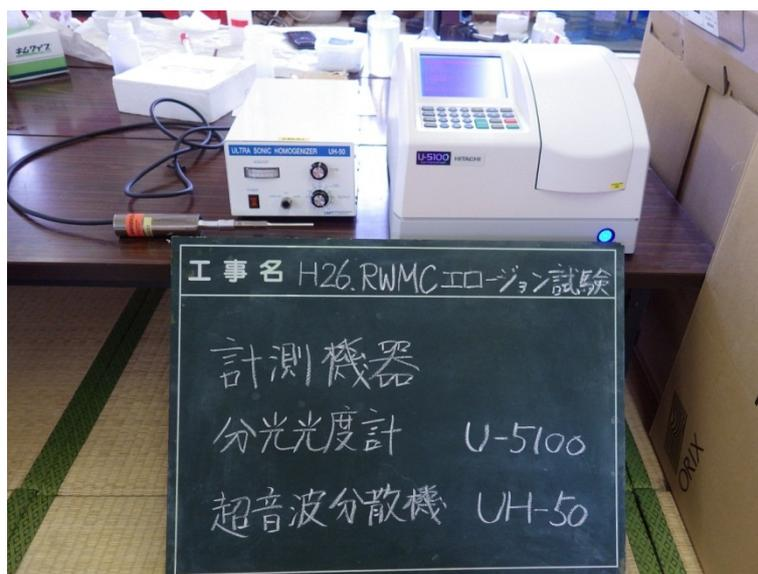
図 10.12.7-1 分光光度計 U-5100 および超音波分散機 UH-50
