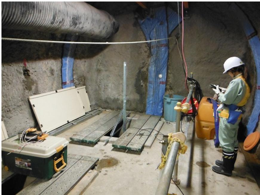
図 10.7.2-6 流向流速測定状況
