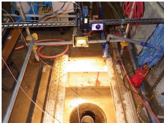
図 10.11.2-3 撮影機材の設置 (上：CCD カメラ、下：ビデオカメラ)
