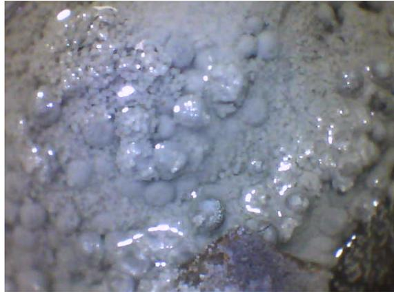
図 10.12.5-4 同位置でのベントナイトペレットの膨潤状況（再冠水開始 20 分後）
