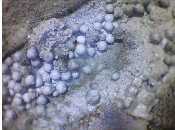
図 10.12.5-1 同位置でのベントナイトペレットの膨潤状況（再冠水開始直後）
