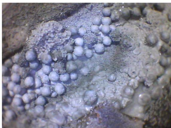
図 10.12.5-3 同位置でのベントナイトペレットの膨潤状況（再冠水開始 15 分後）
