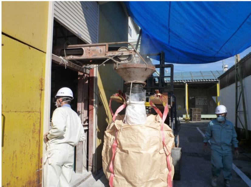
図 10.5.1-10 混合材料のフレコンバックへの収納
