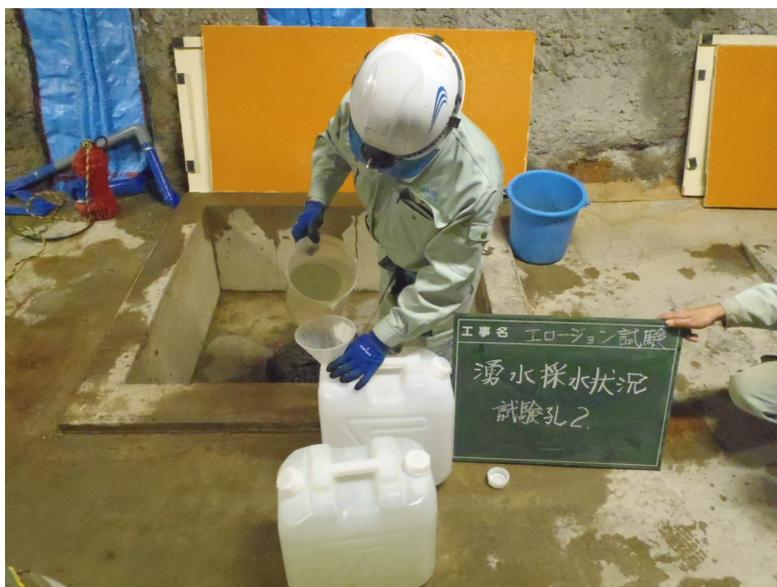
図 10.8.1-1 地上試験用の湧水採水状況 (試験孔 2)
