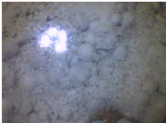
図 10.12.5-6 同位置でのベントナイトペレットの膨潤状況（再冠水開始 30 分後）
