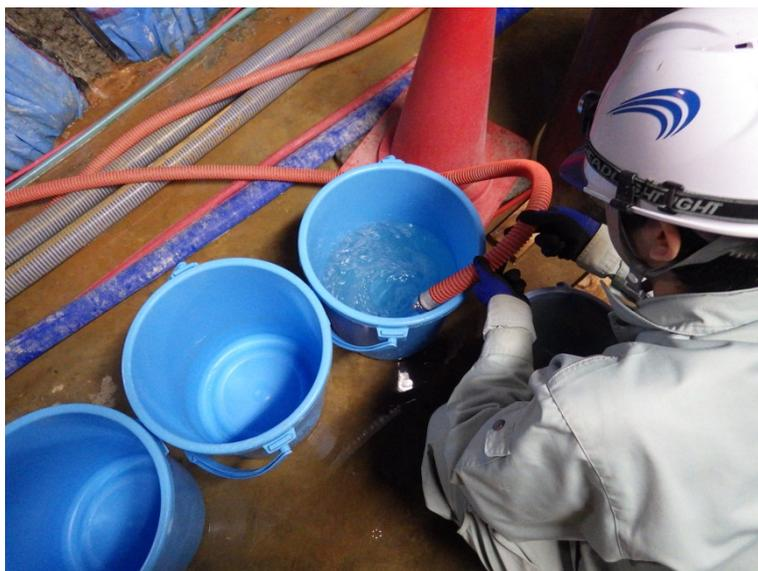
図 10.11.3-2 ポンプによる採水状況
