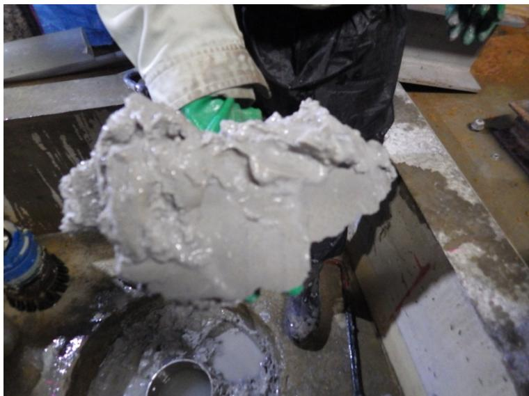
図 10.12.4-3 岩盤との付着状況確認（取り出した試験体）
