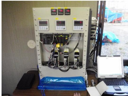
図 9.4.2-6 制御機器 (シーケンサ、モータドライバ、PC)
