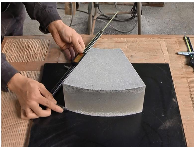
図 10.5.2-8 表面状態の確認及び寸法測定
