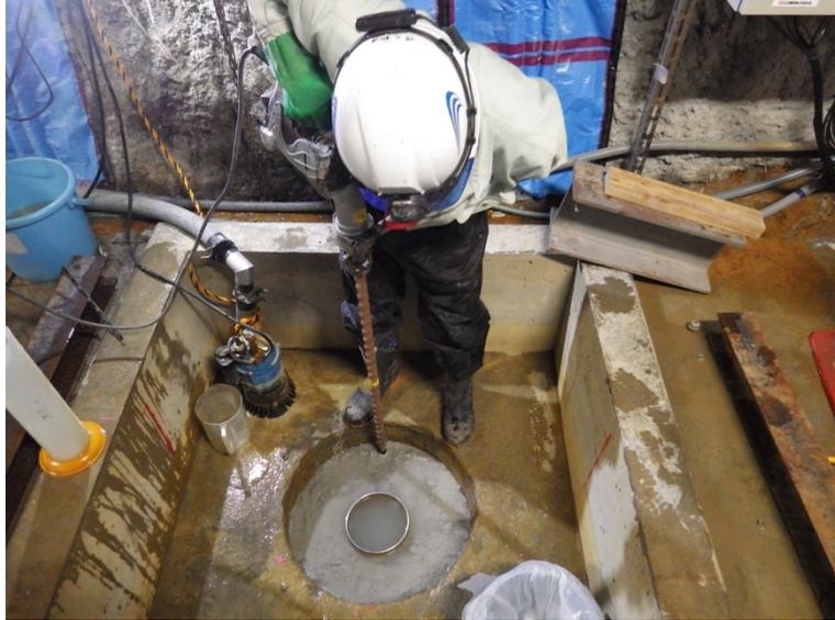
図 10.12.4-2 岩盤との付着状況確認（試験体取出し作業）
