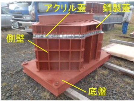
図 9.2.1-2 実規模 1/4 リングモールド外観
