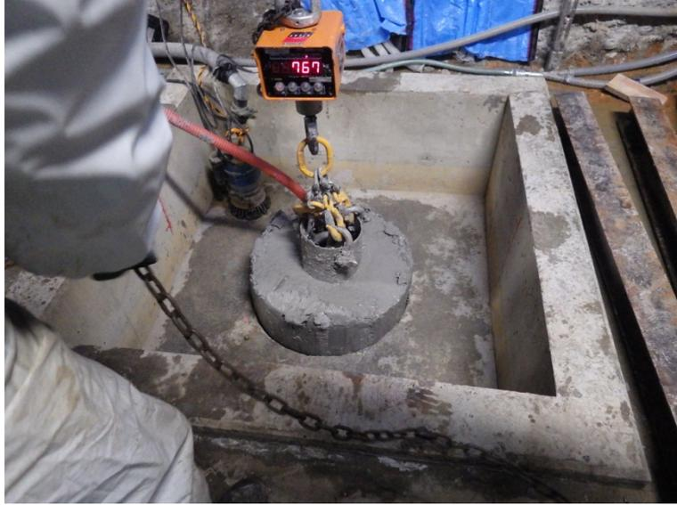
図 10.12.4-4 チェーンブロックによる試験体引上げ状況
