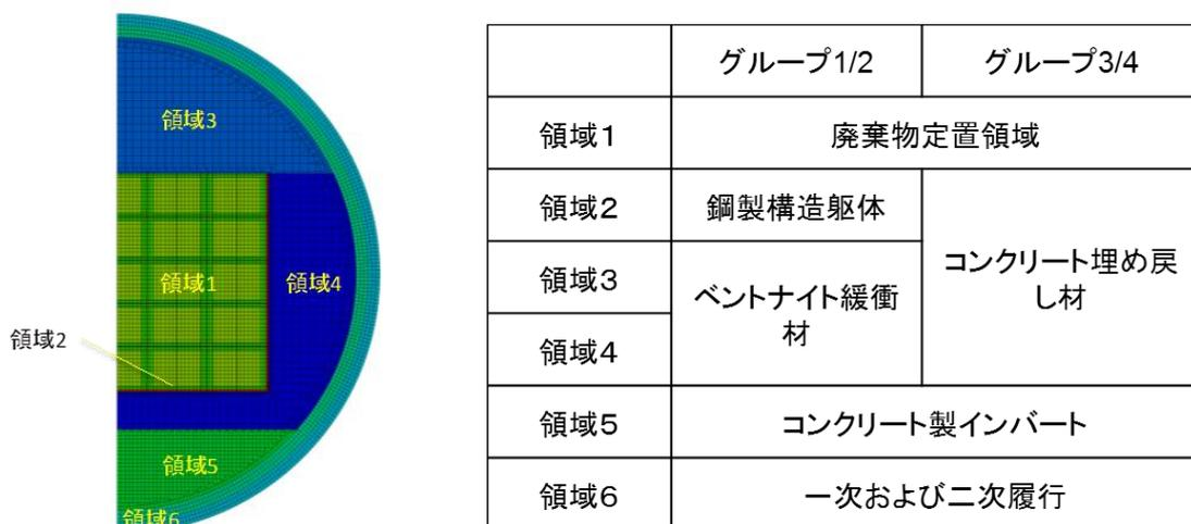
図 3.3.1-1 試解析の対象とする処分システムの概念
