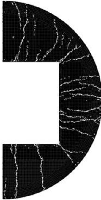
図 2.3.5-3 DEM 大規模解析結果に対する連続亀裂評価例
