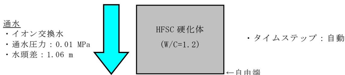
図 2.1.4-1 化学反応－物質輸送連成解析の体系
