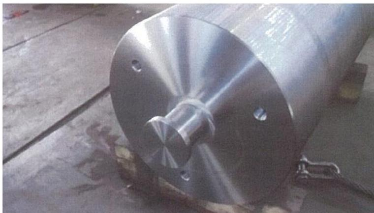
图 4.3.2-11 最終機械加工後外觀圖
