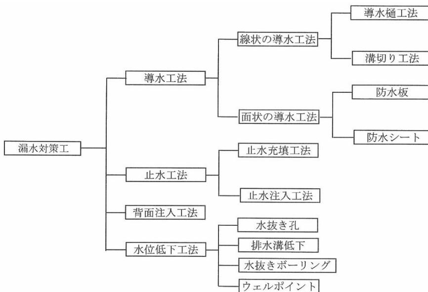
図 6.3.1-7 主な漏水対策の分類 (道路・鉄道トンネルの例)
