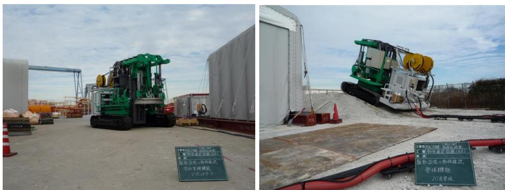
図 4.3.3-1 駆動設備の動作確認試験状況
