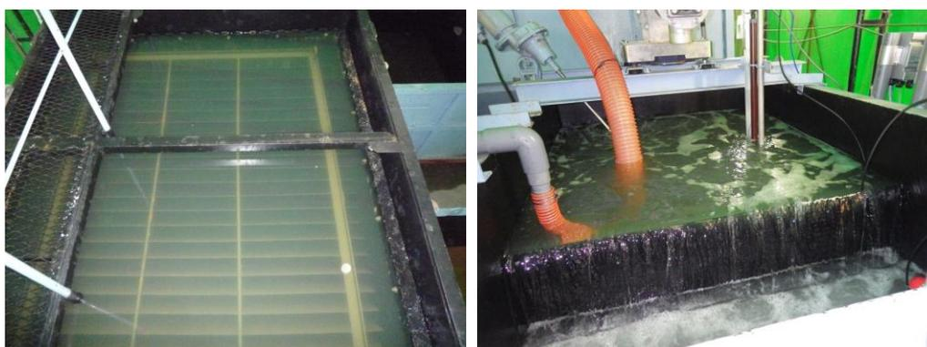
図 4.3.3-4 塩水リユース設備の動作確認試験状況
