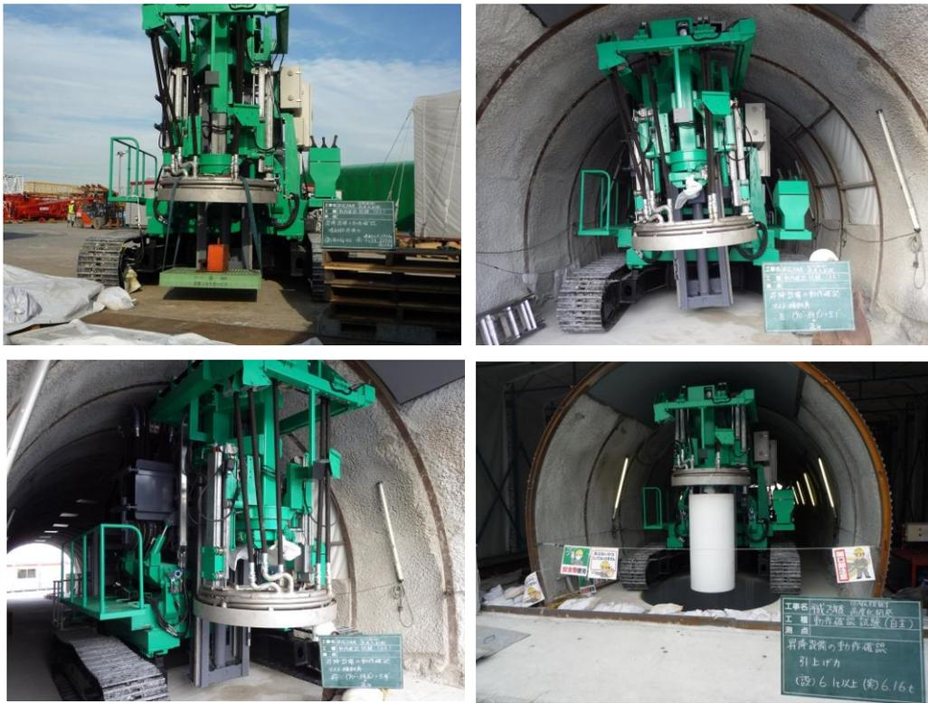
図 4.3.3-2 昇降設備の動作確認試験状況
