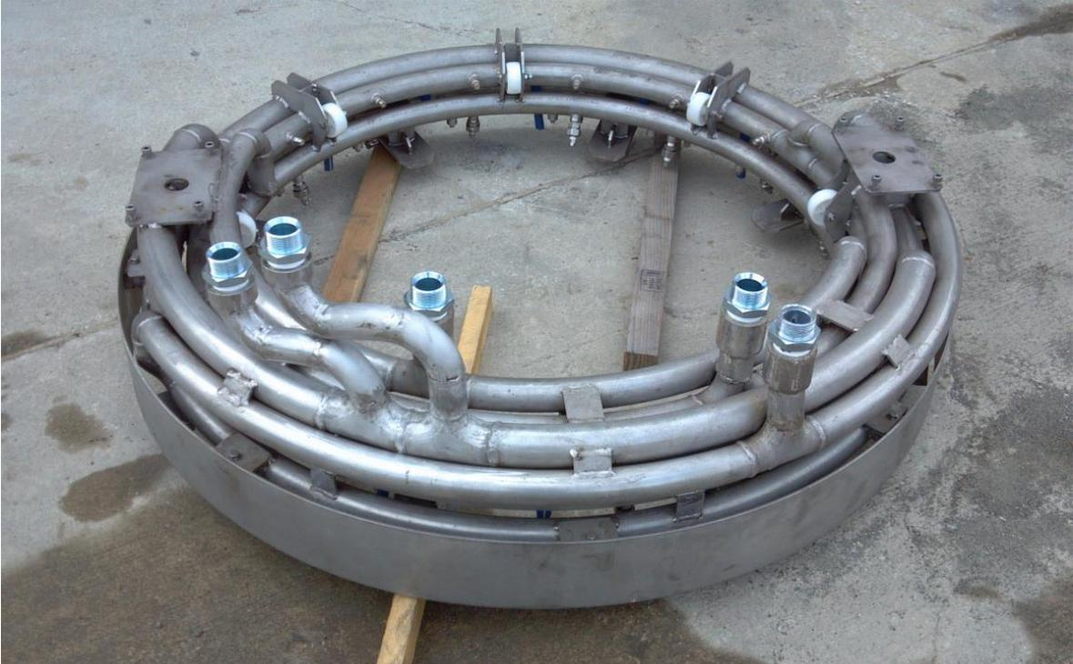
図 4.2.2-1 塩水噴射・スラリー吸引設備の状況
