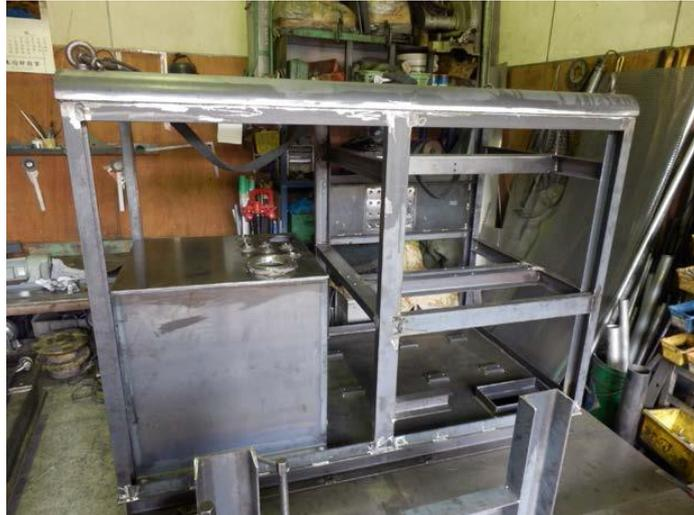
図 3.1.3-7 【油圧ユニット部】外部フレーム製作状況
