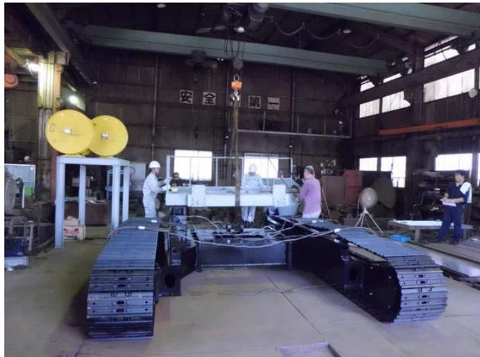
図 3.1.3-17 【駆動設備全体】 油圧ユニットフレーム組立状況 1
