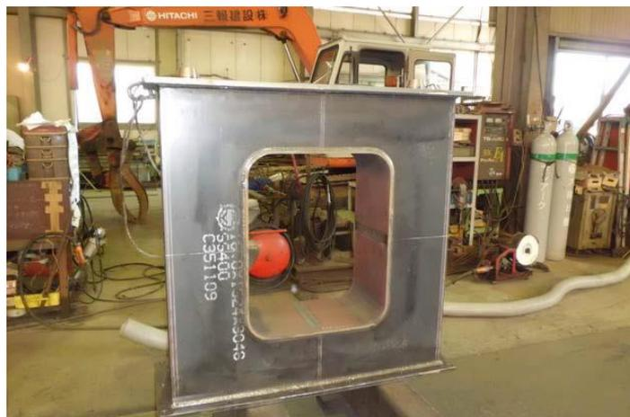
図 3.1.3-1 【走行部】トラックフレームセンター部製作状況
