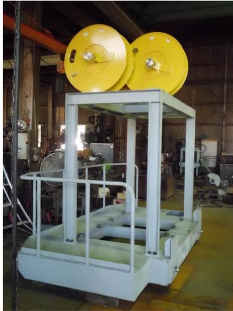
図 3.1.3-16 【駆動設備全体】 油圧ユニットフレーム製作状況
