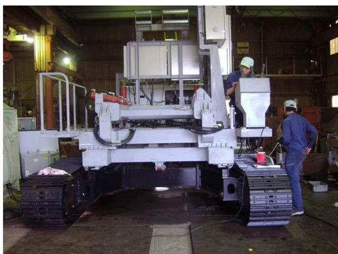
図 3.1.3-21 【駆動設備全体】油圧ユニット組立状況（配線完了）
