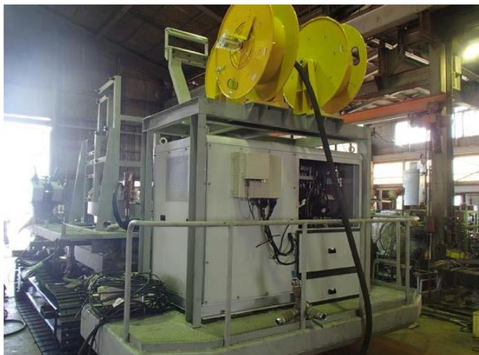
図 3.1.3-19 【駆動設備全体】油圧ユニット組立状況
