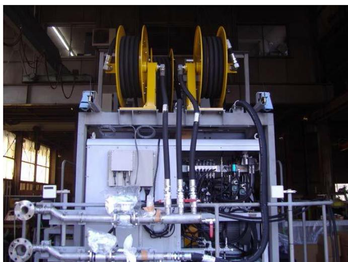
図 3.1.3-20 【駆動設備全体】油圧ユニット組立状況（配管完了）
