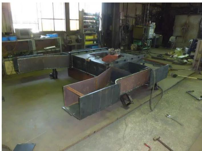
図 3.1.3-2 【走行部】トラックフレームサイド部製作状況
