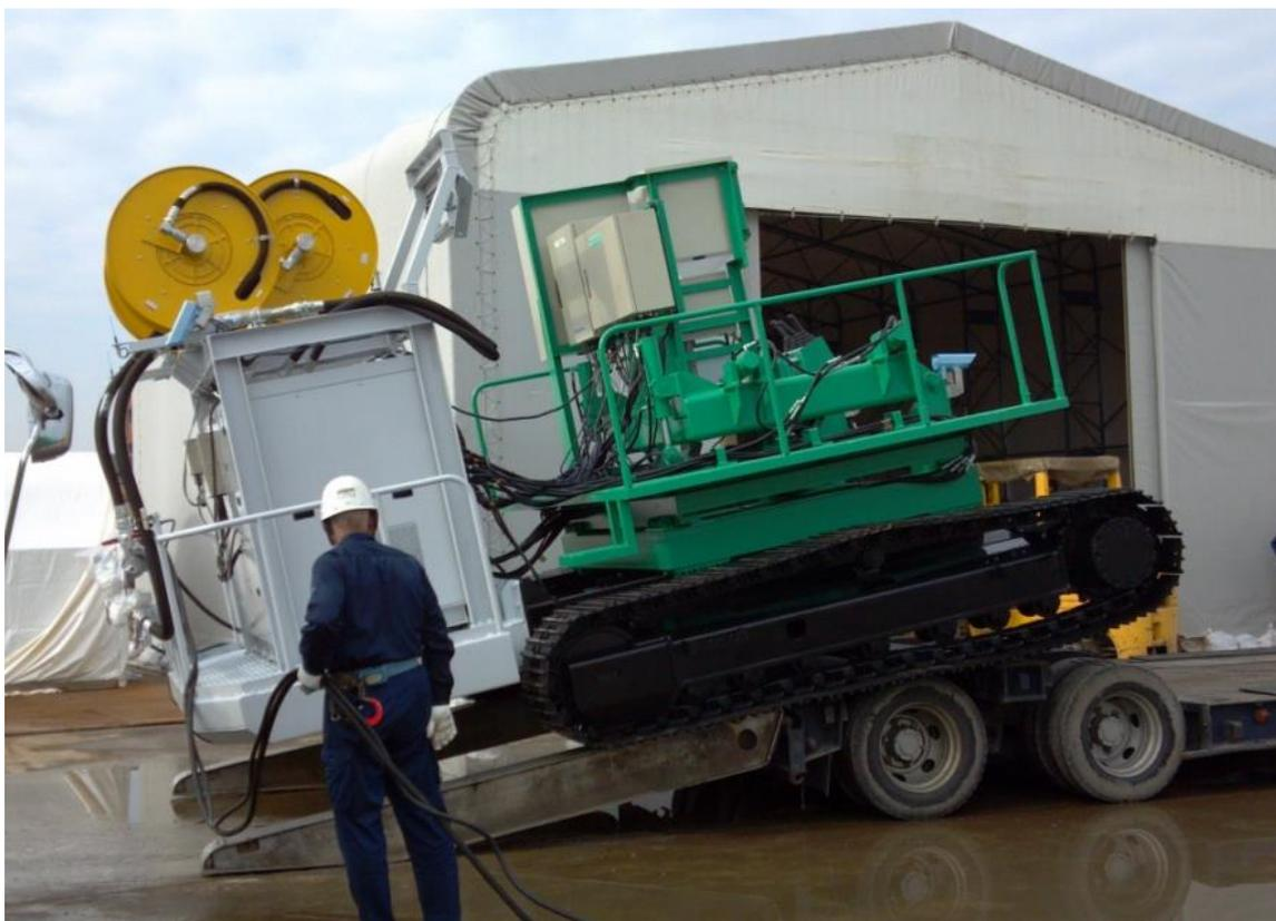
図 4.2.3-2 油圧ユニット組立状況（製作工場にて実施）
