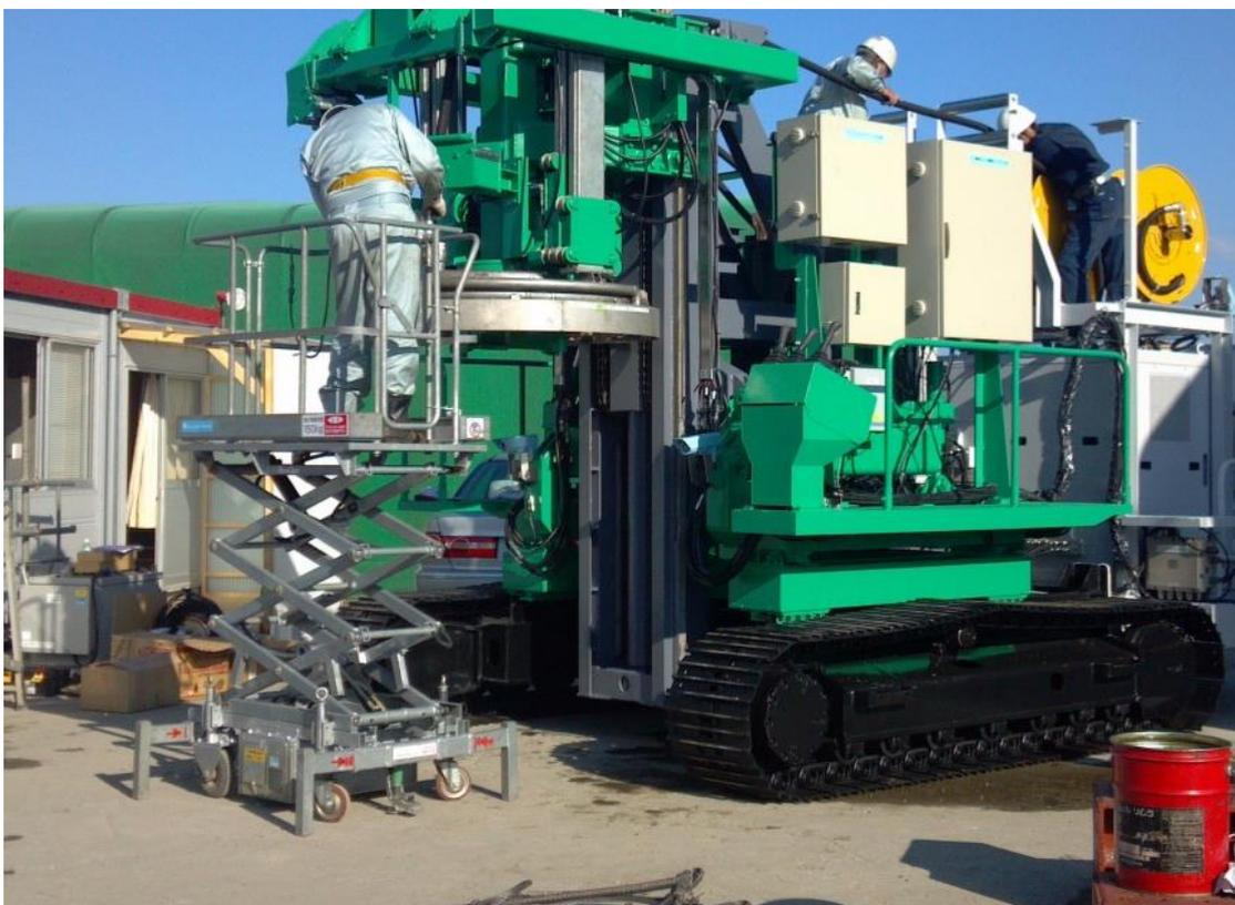
図 4.2.3-5 塩水噴射部組立状況
