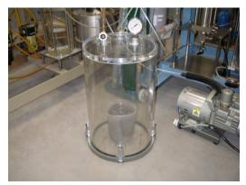
写真 3.4-7 真空槽を用いた脱気浸水法によ 写真 3.4-8 透水試験直前の供試体状況 るモルタルの初期飽和状況
