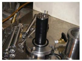
写真 3.4-9 モルタル供試体へのゴムジャケ 写真 3.4-10 試験装置へのモルタルセット完 ット装着状況
