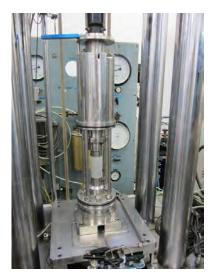
写真 3.4-5 モルタルの一軸圧縮強度測定状 写真 3.4-6 一軸圧縮強度試験後のモルタル 況 (n=3)
