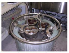
写真 3.4-4 端面研磨状況
