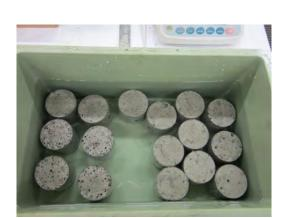
写真 3.4-3 供試体の水中養生状況 (透水・ 透気試験用、および一軸圧縮強度確認用)
