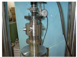
図 2.5-3 試料とモールドの準備(左)および供試体の静的圧縮整形(右)
