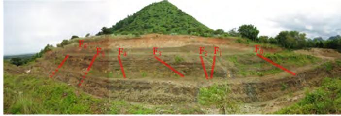
図 1.3.4-6 Saile 鉱山採石場の全体写真と断裂系（背後は Malabobo 安山岩プラグ）
