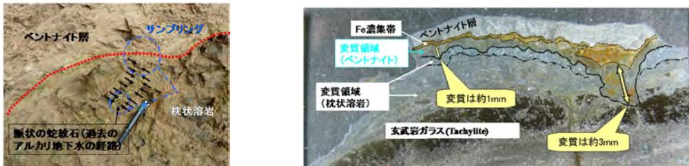
(a) トレンチ-5 の断面写真と試料採取位置 (b) 薄片試料のベントナイトー枕状溶岩界面の状態
