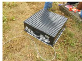
(b)受信装置（各測点に設置し信号を受信）
