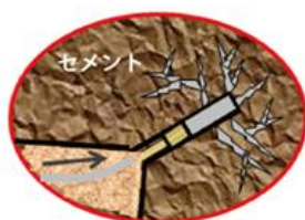
【セメント系材料 注入後】
