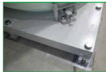
キャスクは10本のボルトで床に固定
