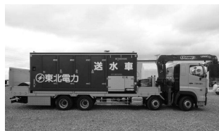
代替非常用冷却海水ポンプ （東通原子力発電所）
