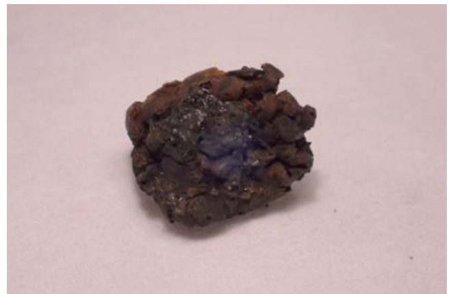
【第111-5-5】2号機原子炉格納容器内部から採取した燃料デブリ
