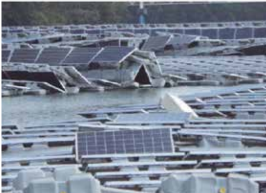
【第123-2-7】台風15号によるパネル破損
